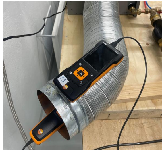
Bild 4.5: Mätning lufttillstånd efter kylbatteri ( t_{2,luft} )
