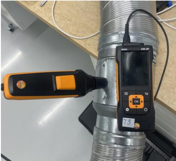
Bild 4.4: Mätning lufttillstånd innan kylbatteri ( t_{1,luft} )
