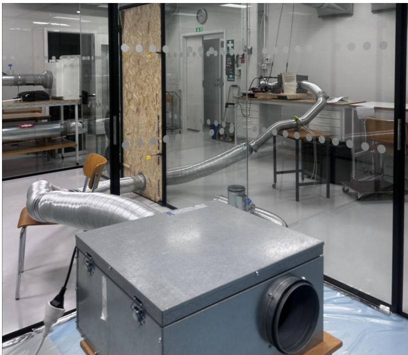
Bild 4.3: Tilluftsläkt med tillhörande kanalsystem från provrum till aggregat
