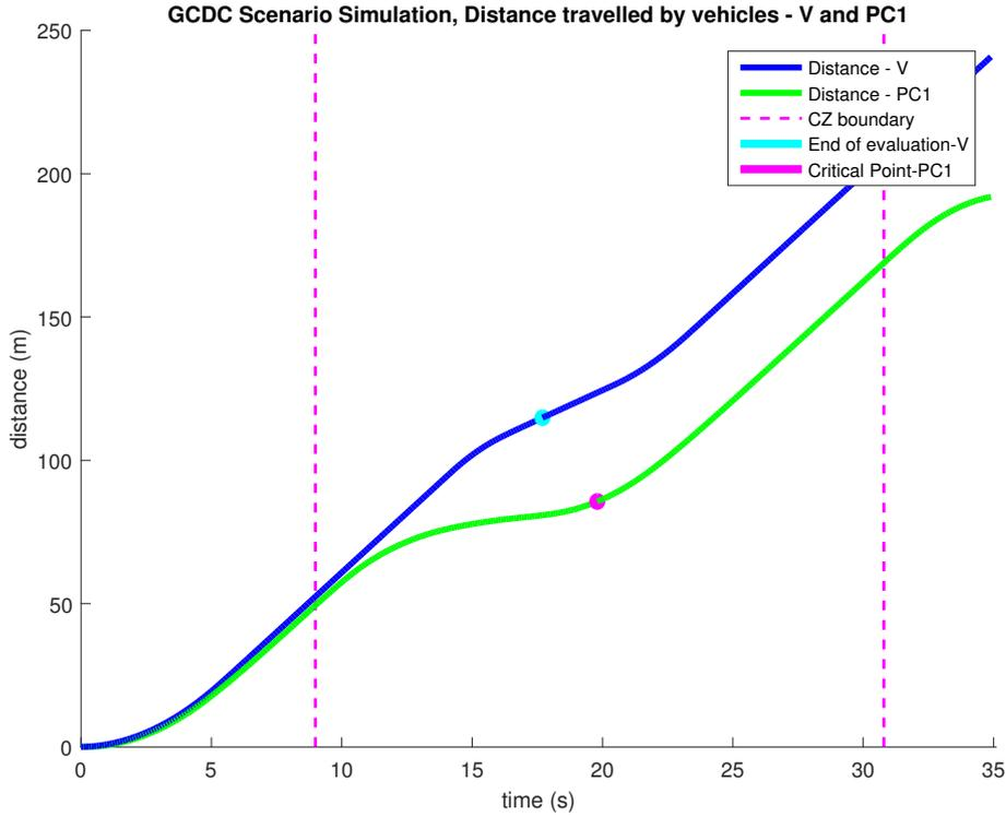
**Figure 5.3:** Position of  $V$  ( $P_V(k)$ ) and  $PC1$  ( $P_{PC1}(k)$ ) inside CZ
