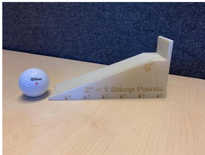
Figur 16: En stimpmeter tillverkad av författarna, modell designad av användaren pozzituwp på hemsidan "Thingiverse"
