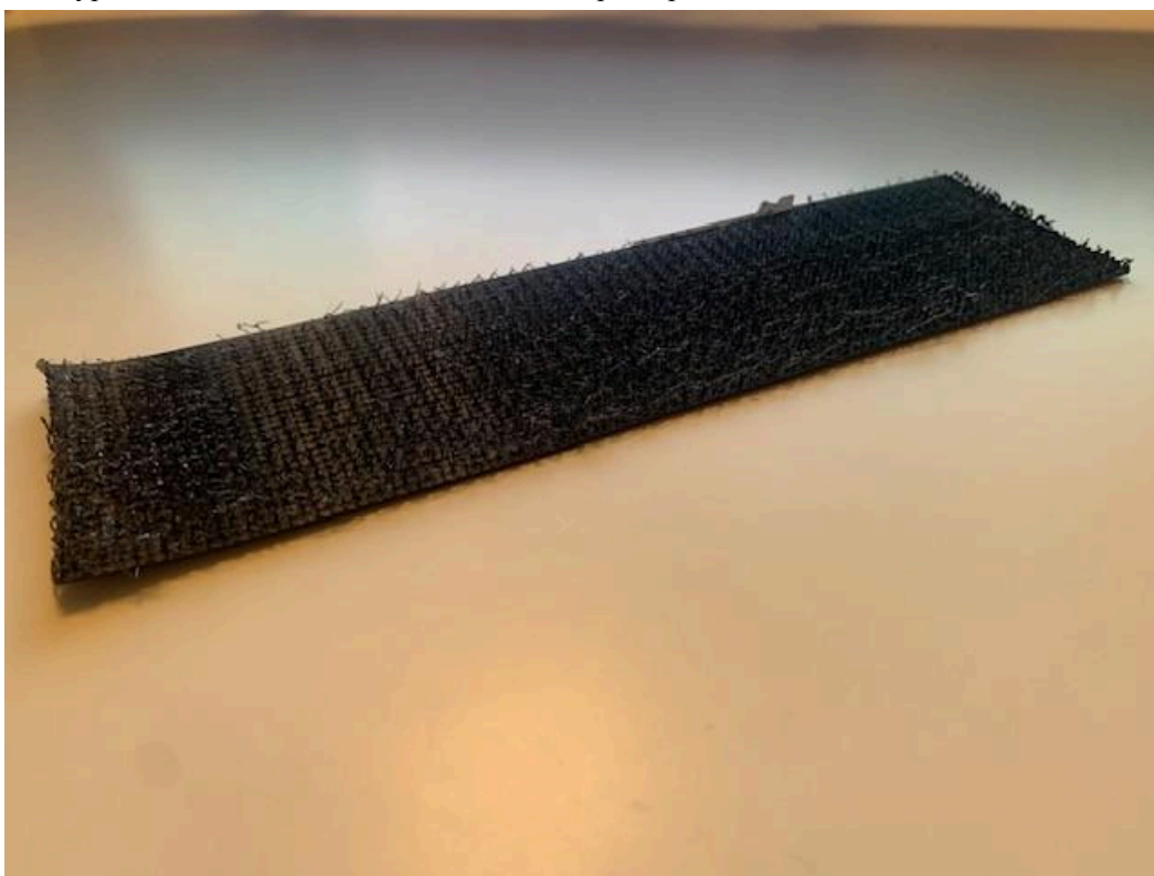
Prototyp 3 av PLU 95A med 2,5 mm höjd på staplar
