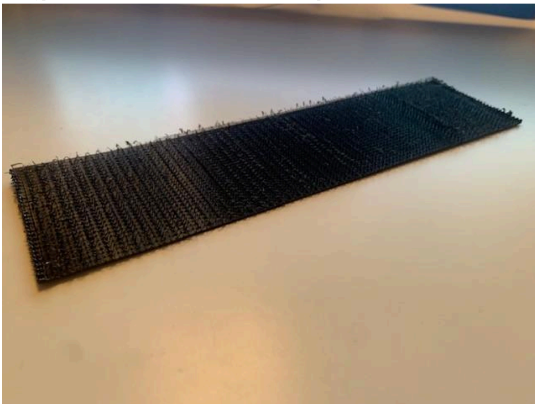
Prototyp 3 av PLU 95A med 10 mm avstånd mellan staplar
