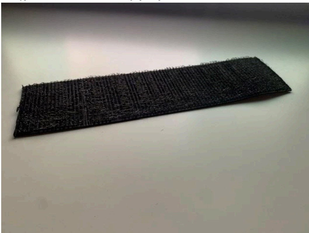
Prototyp 3 av PLU 95A med 2,5 mm höjd på staplar
