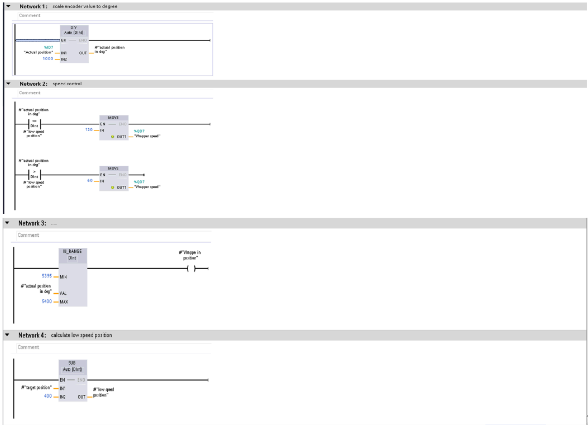
Figur 4.3.12. PLC-struktur för styrblocket.
