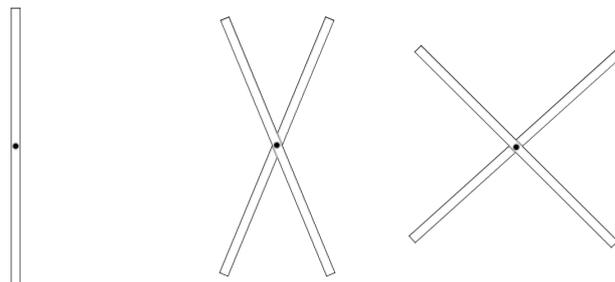
**Figure 3.35:** Basic scissor module
