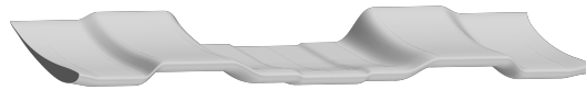
(c) R23. Samtliga element har skalats av från O23 för att kunna studera flödesfältens utseende för en lågpresterande vinge.
