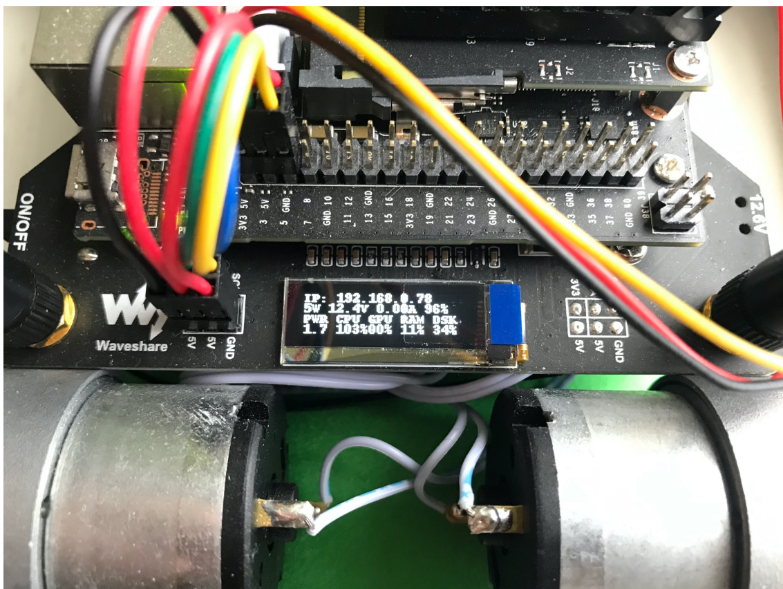
Figur 7. Den lilla displayen på bilens ovansida visar att bilen är i 5-watts-lägen (5W).
