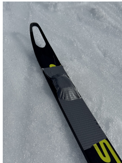
Figur 4.3: En IMU fastsatt med silvertejp på främre delen av skidan.
