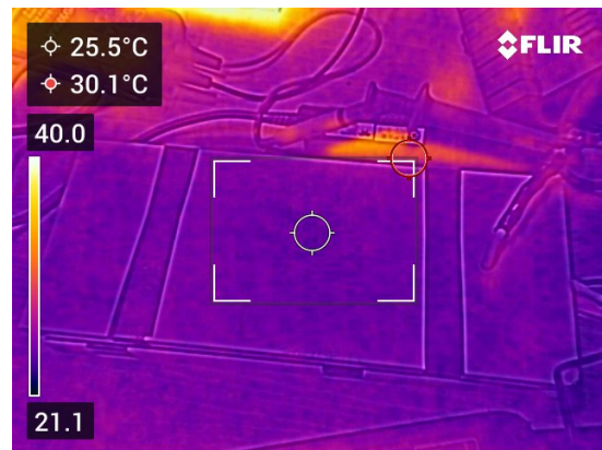
(d) Värmeutveckling för spolarna.
