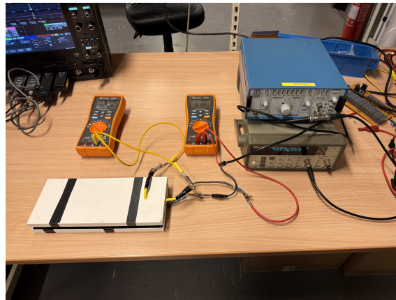
Figur 3.17: Uppmätning av ömsesidig induktans.
