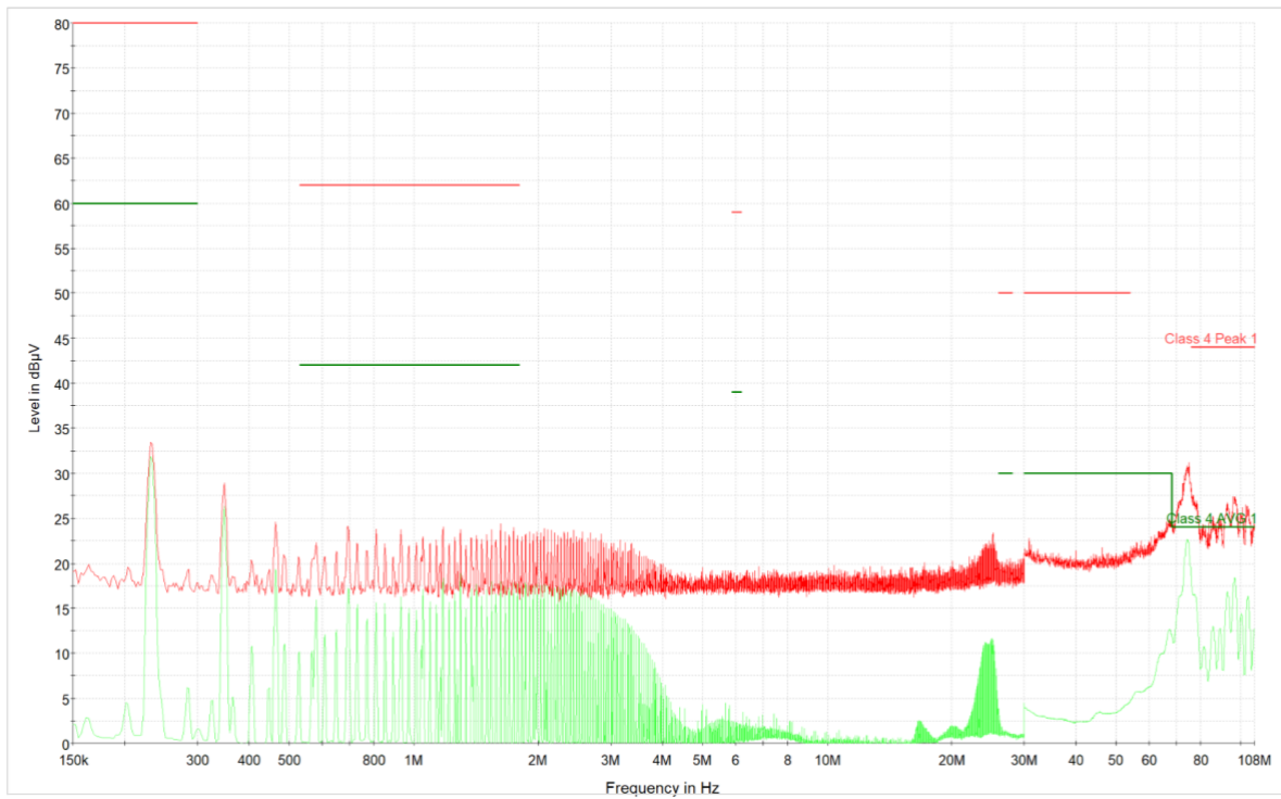
Figur C7. Ledningsbunden emission i minussidan vid 70 \Omega belastning.
