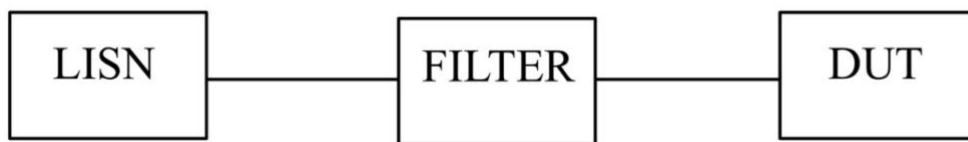
Figur 3.9: Blockschema över mätupställningen med LISN samt EMI-filter på ingångssidan till omvandlaren (DUT).
