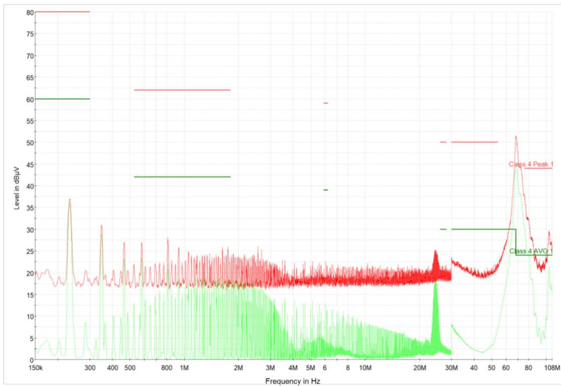
Figur 4.5: Emissionsnivåerna på minussidan, med en större ingångskondensator, visar en kraftig dämpning på cirka 40 dB \mu V vid första emissionstoppen runt 220 kHz. Nivåerna ligger under gränsvärdena upp till cirka 70 MHz.
