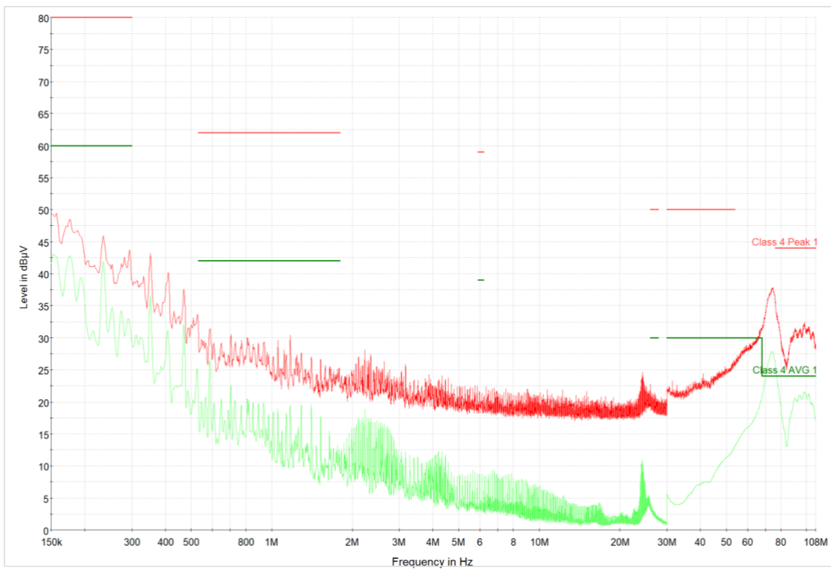
Figur C5. Ledningsbunden emission i minussidan vid 5 \Omega belastning.
