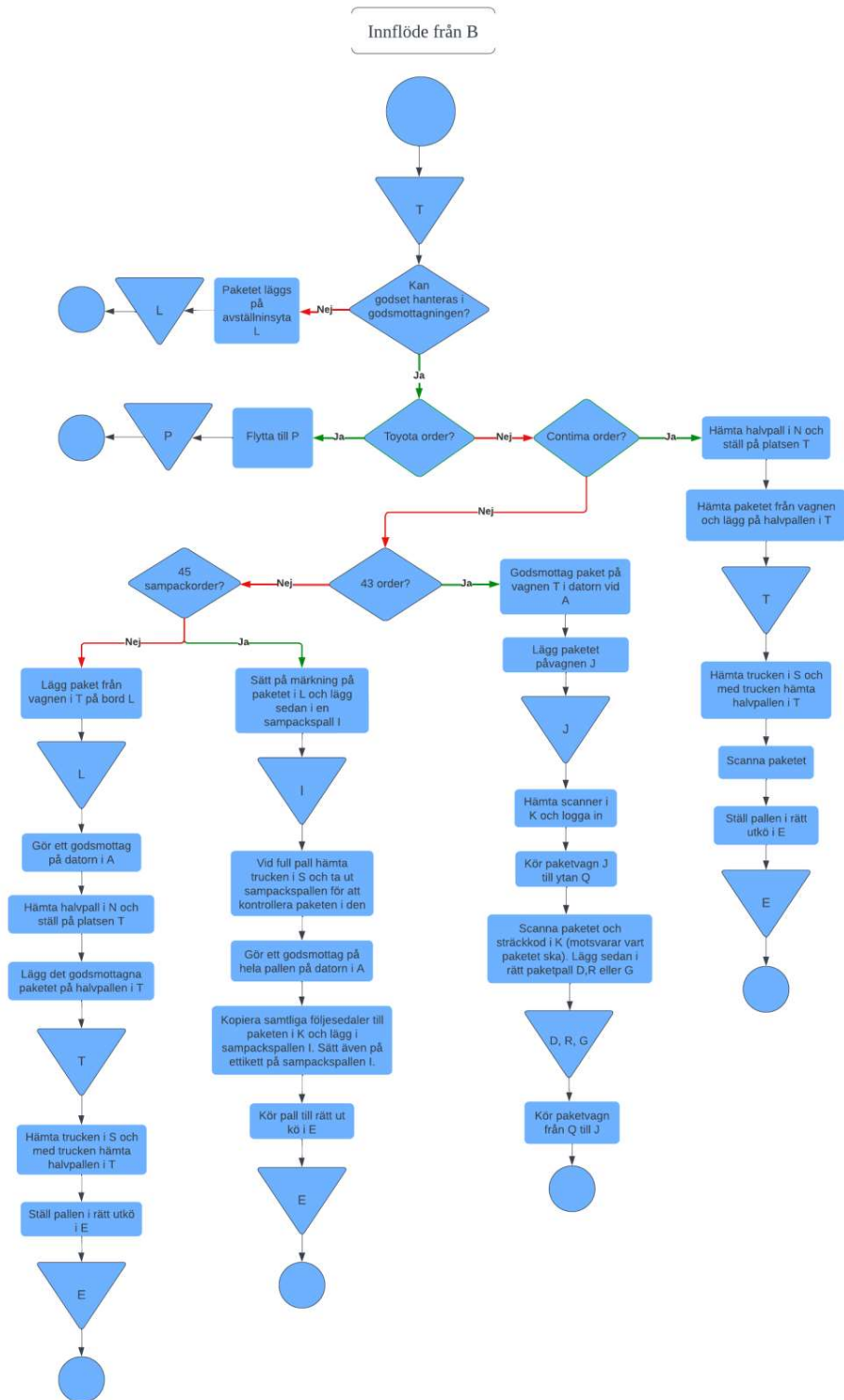
Figur 18. Flödesschema för inkommande gods från B.
