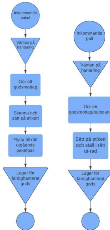
Figur 29. Generella processflödesdiagram för paket och pall.
