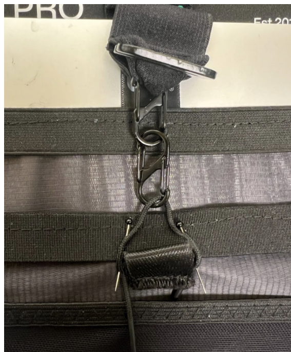
Figur 5.12: Karbinhakar som fäste
