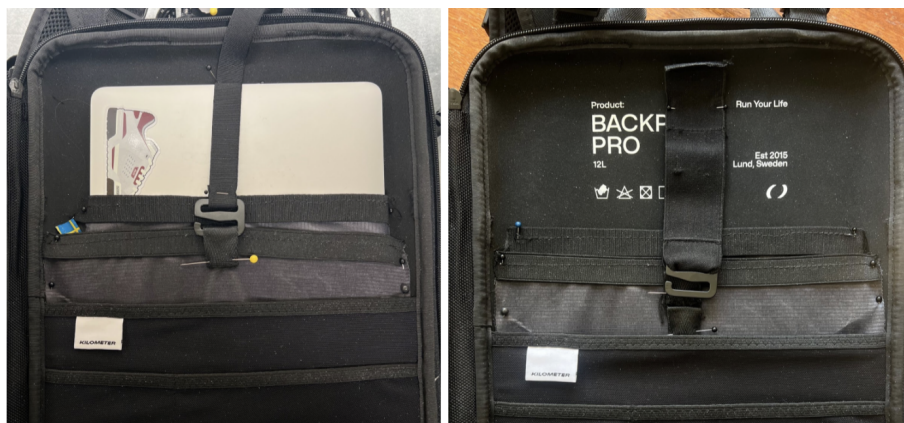
Figur 5.15: Omplacering av datorfack (höger) och test med bredare resårband och två öglor för fäste (vänster).
