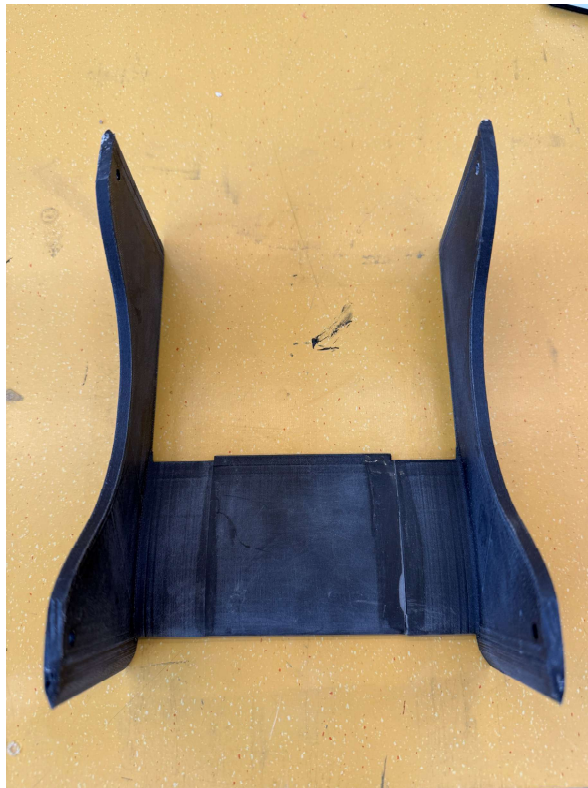
Figur 3.20: Huvudbärplanet med infästning sett ovanifrån.
