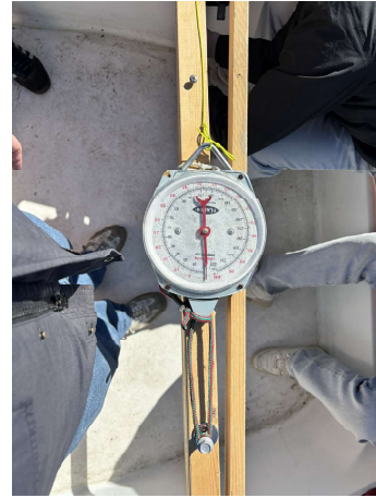
(b) Figuren visar bogserslinans infästning i vågen samt vågens koppling till bommen.
