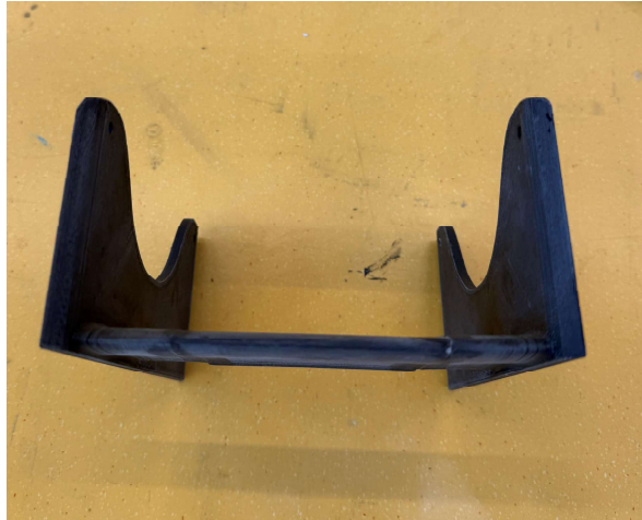
Figur 3.19: Huvudbärplanet med infästning sett framifrån.
