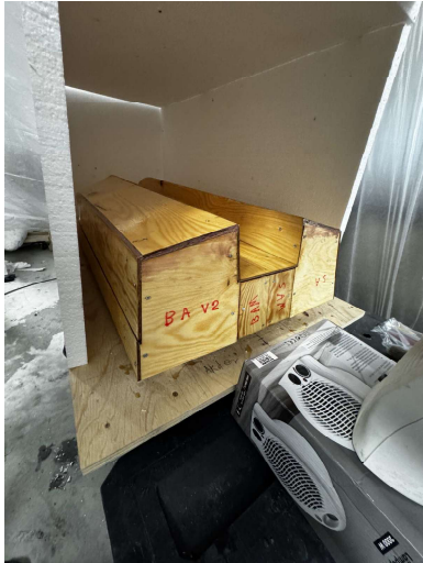
Figur 3.7: Härdning av kompositen med hjälp av cellplast och värmefläkt.
