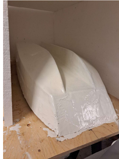
Figur 3.8: Härdning av gelcoat innan slipning.
