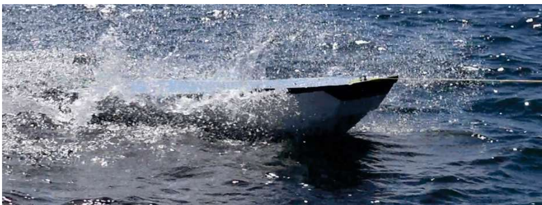
Figur 4.7: Modellen utan bärplan i motsjö och lastfall 2.
