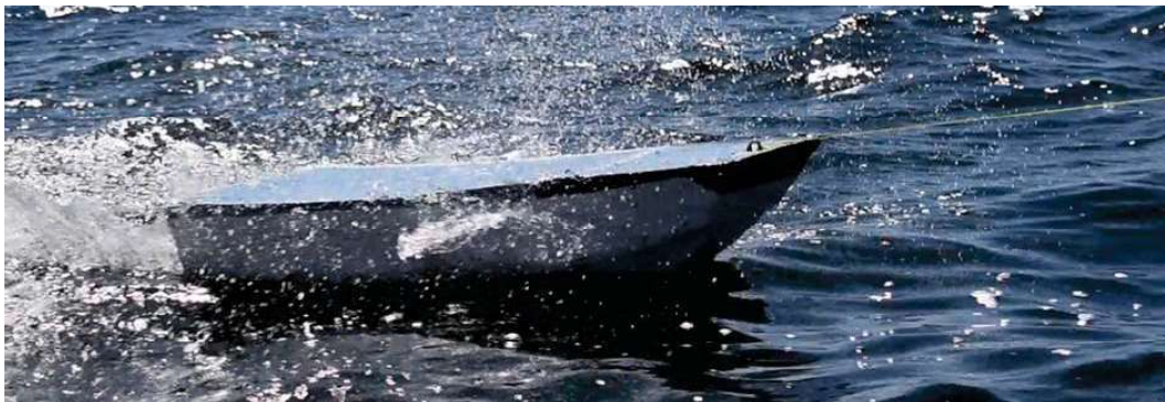
Figur 4.6: Modellen utan bärplan i motsjö och lastfall 1.
