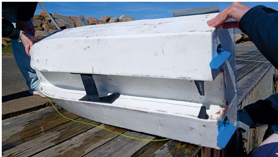
Figur 3.22: Modellen med alla bärplan monterade. Foto: Sten Örneblad.
