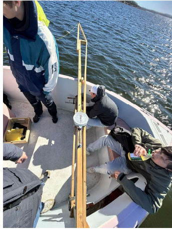
(a) Figuren visar bommen som användes till testtriggen med infäst våg och gul lina. Linan är fäst i vågen, som i sin tur är monterad till bommen med en skruv och tamp. Linan leds längs bommen till en trissa placerad vid bommens ände, där den ändrar riktning och används för att dra båten under försöket.
