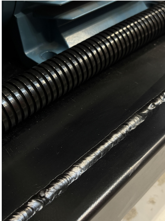
Figur 5.3: Bottenplattan svetsad i ramen.
