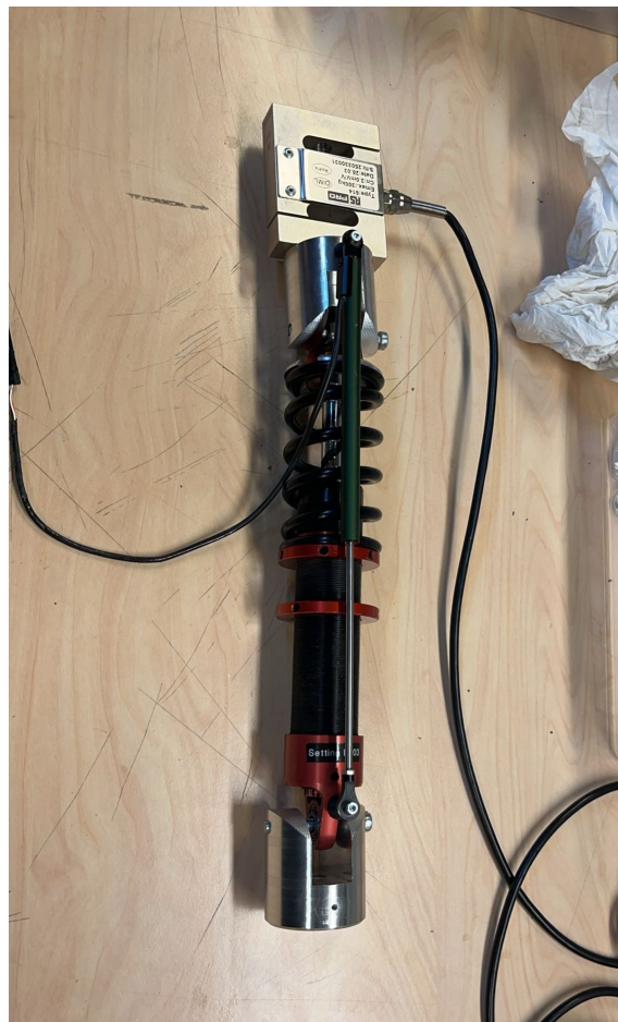
Figur 5.17: Linjärpotentiometer monterat parallellt med stötdämparen samt lastcellen monterad vid övre dämparinfästning.
