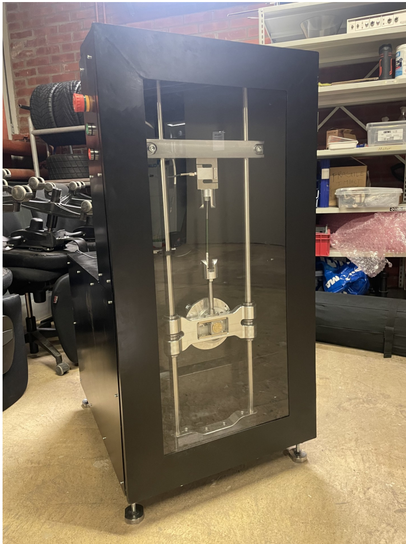
Figur 6.1: Mekanisk konstruktion med sidopaneler och säkerhetsdörr.
