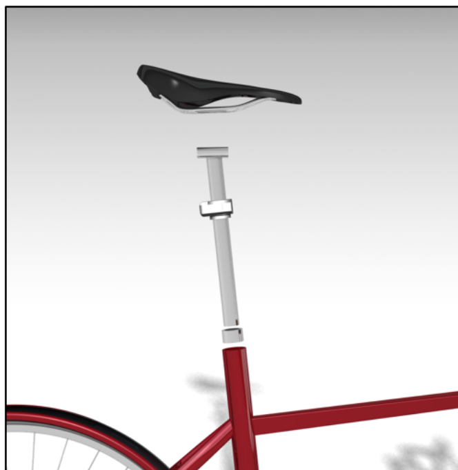
Figur 4.44: Sprängningsvy av sadelstolpe med quick release
