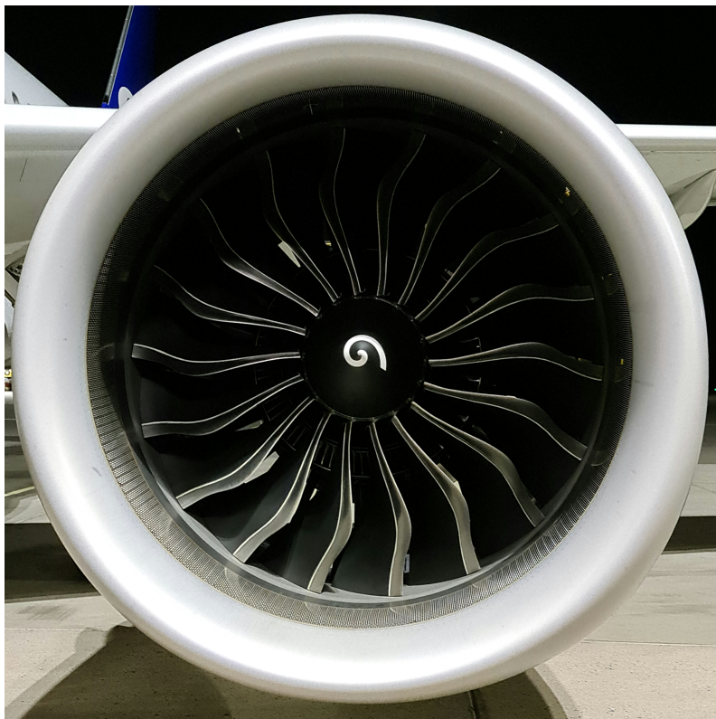
Figur 2.5: Framsidan av turbofläktmotor, CFM International LEAP-1A, monterad på en Airbus A320neo.
