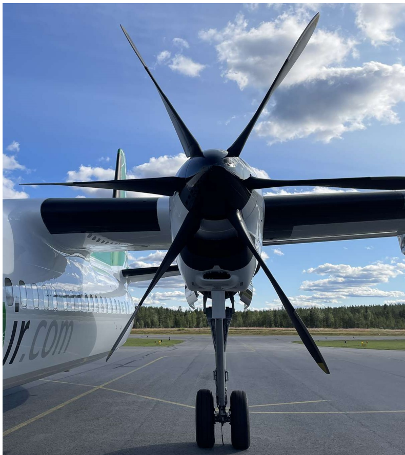
Figur 2.9: Framsidan av turbopropmotor, Pratt & Whittney PW100, monterad på en Fokker F50.
