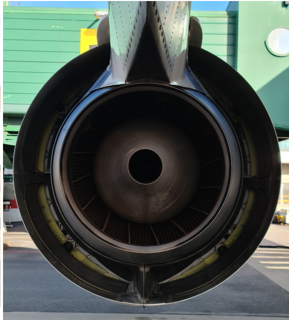
Figur 2.7: Baksidan av äldre turbofläktmotor, CFM International CFM56-B, monterad på en Airbus A320ceo.
