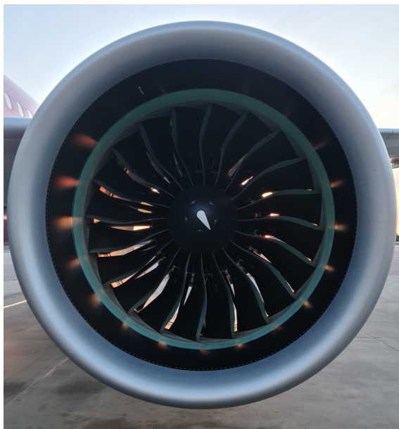
Figur 3.1: Framsidan av växlad turbofläktmotor, Pratt & Whitney PW1000G, monterad på en Airbus A320neo.
