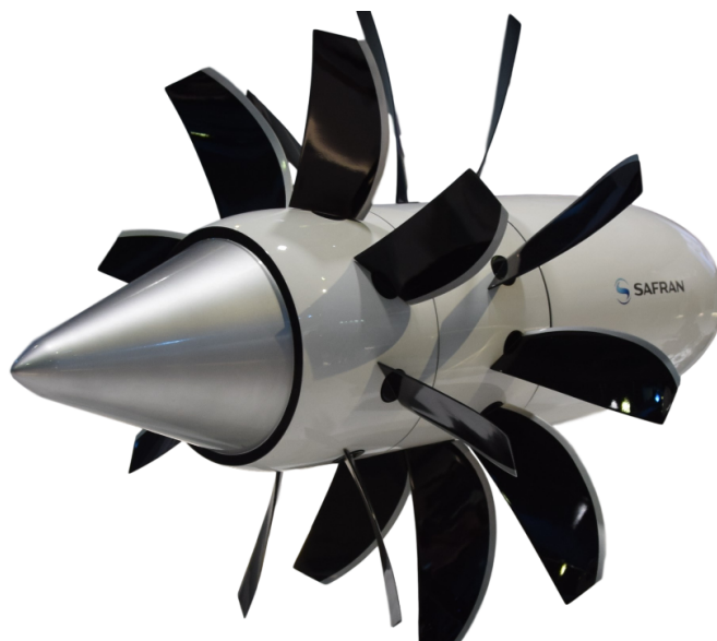
Figur 3.3: Open rotormotor från Safran, (Tiraden, 2017). CC BY-SA 4.0.
