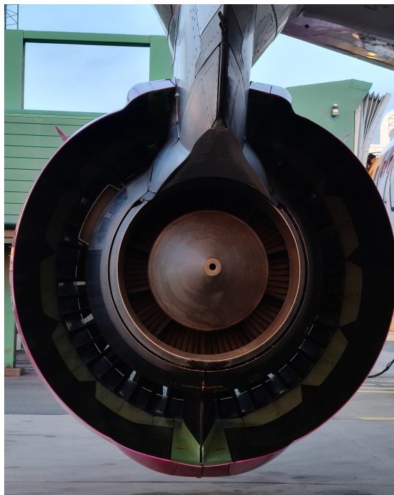
Figur 3.2: Baksidan av växlad turbofläktmotor, Pratt & Whitney PW1000G, monterad på en Airbus A320neo.
