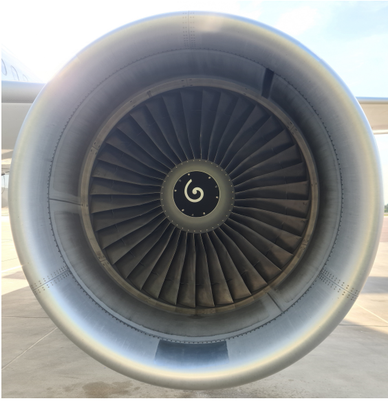
Figur 2.6: Framsidan av äldre turbofläktmotor, CFM International CFM56-B, monterad på en Airbus A320ceo.
