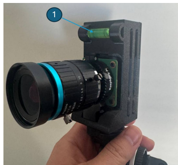
Figur 5.20: Kapsling för Raspberry Pi HQ-kamera där (1) visar det integrerade vattenpasset.
