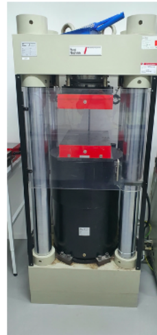
(b) Kubpress som användes för att testa tryckhållfasthet.
