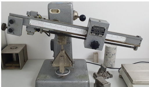
(a) Maskin, som testar böjdragshållfasthet, vilken användes för att dela provkropparna på mitten.
