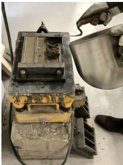
Figur 5: Form placerad på vibrationsbord. Steget utfördes under laborationens tredje etapp.
