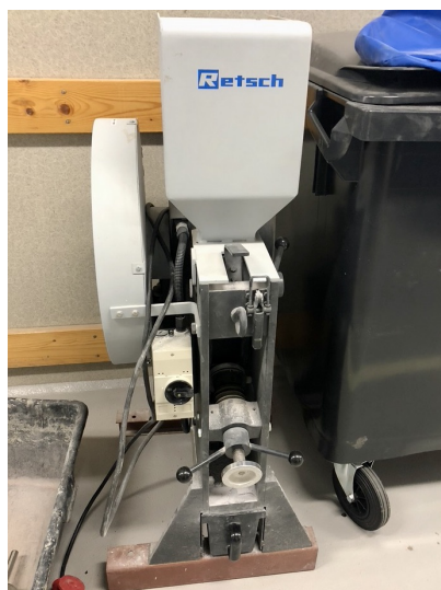
(a) Jaw Crusher av märke Retsch, krossar musselskal.
