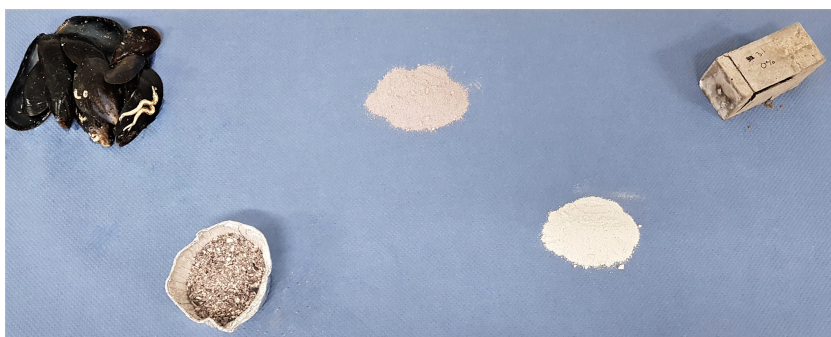
Figur 2: Skal i olika stadier under arbetet. Från vänster: hela, krossade, malna, calcinerade, gjutna i bruk.
