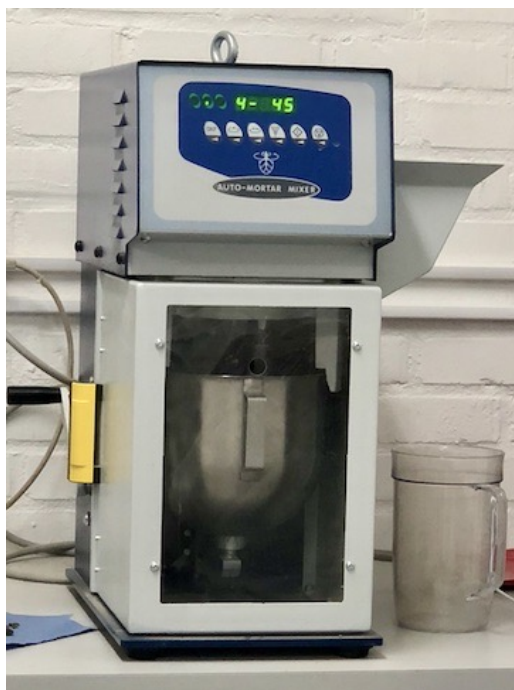
Figur 4: Mixer för blandning av bruk i etapp 2.
