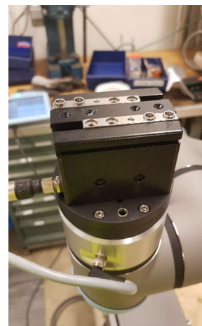
Figur 11 Elektrisk greppverktyg monterat
