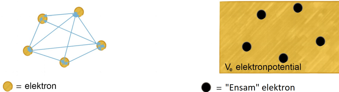
Figur 5: Förenklingen som uppnås m.h.a. DFT. Baserad på ref. [27], återgiven med tillstånd.
