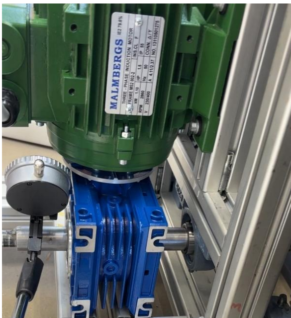
Figur 18 Sammansättning motor och växellåda
