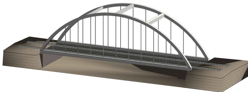
Figur 4: Bågbro i betong ritad i Revit.
