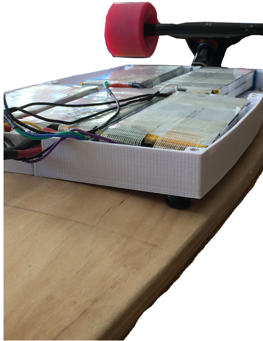
Figur 12: Bild över hur gummibussningarna användes vid fästning av komponentlådorna i brädan
