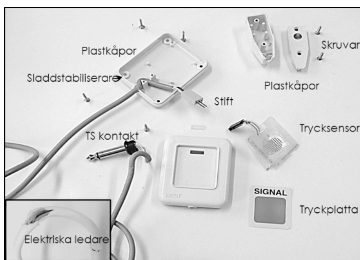
Figur 2.5 Översiktsbild av larmdosans alla komponenter
