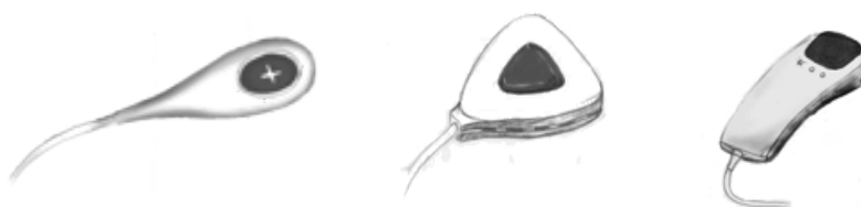
Figur 4.1 Delkoncept larmdosa, från vänster: Lättrengörlig , Tydlig och Ergonomisk dosa
