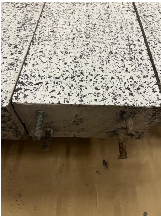
Figur D.3 Utstickande armering för balk B-09.
