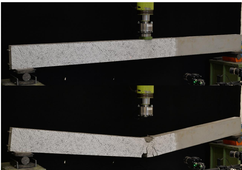
Figur G.2 Balk B-02 före och efter statiskt test.
