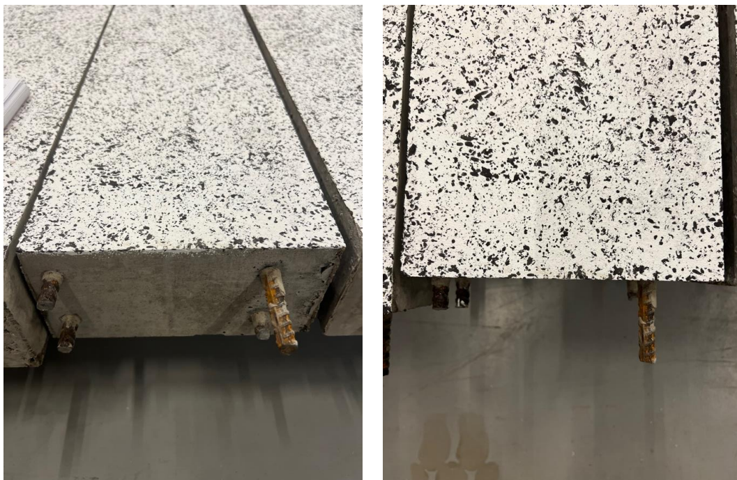
Figur D.1 Utstickande armering för balk B-04.
