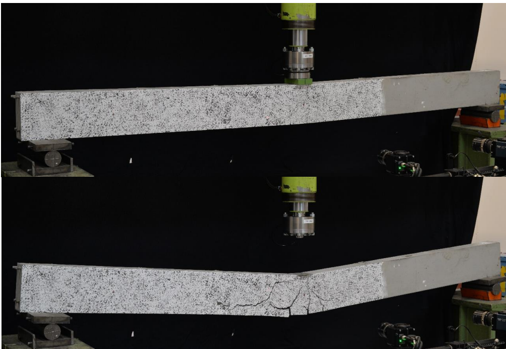
Figur G.16 Balk B-16 före och efter statiskt test.
