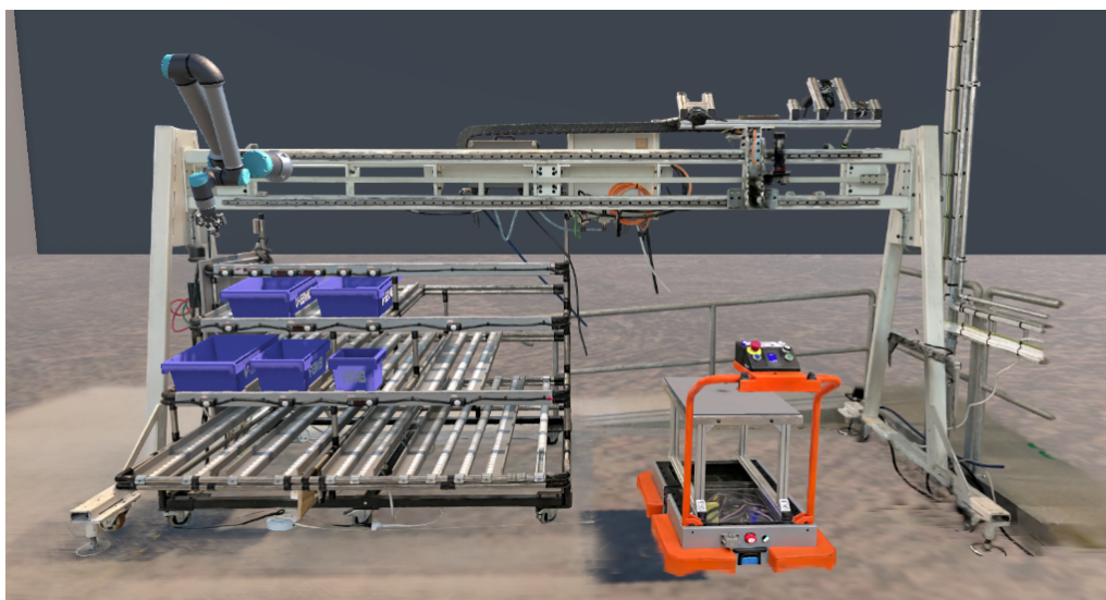
Figur 8.1: Resultat av den digitala tvillingen i Unity med alla implementerade delar. 3DGS-modellen, styrbar cobot, blå CAD-lådor med komponenter och AMR där komponenter placeras.
