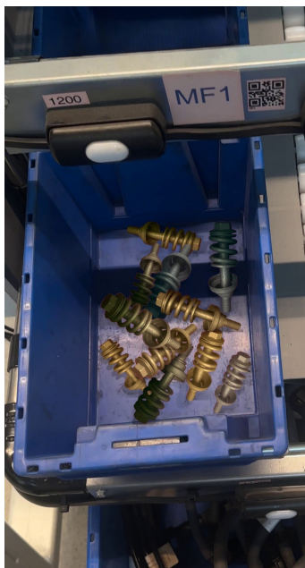
Figur 5.3: Exempel på syntetiskt genererad träningsdata där extraherade komponenter placerats i en låda med varierad position, skala och rotation.
