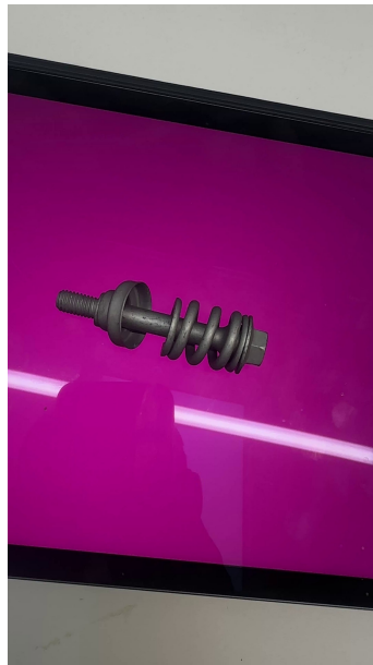
Figur 5.1: Exempel på komponent filmad mot magentafärgad bakgrund. Den tydliga bakgrunden användes för att förenkla automatisk extraktion av komponenten.
