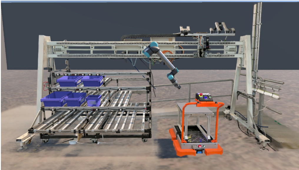
Figur 2.2: Slutligt resultat av den digitala tvillingen, med 3DGS-modell, rörlig cobot, blå lådor med komponenter och Autonom Mobil Robot (AMR) som hämtar kittade komponenter.
