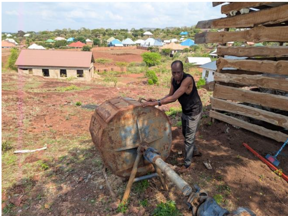
Figur 6 Kulkvarn lokalt tillverkad för småskalig malning (Foto: Raine Isaksson, 2026)
