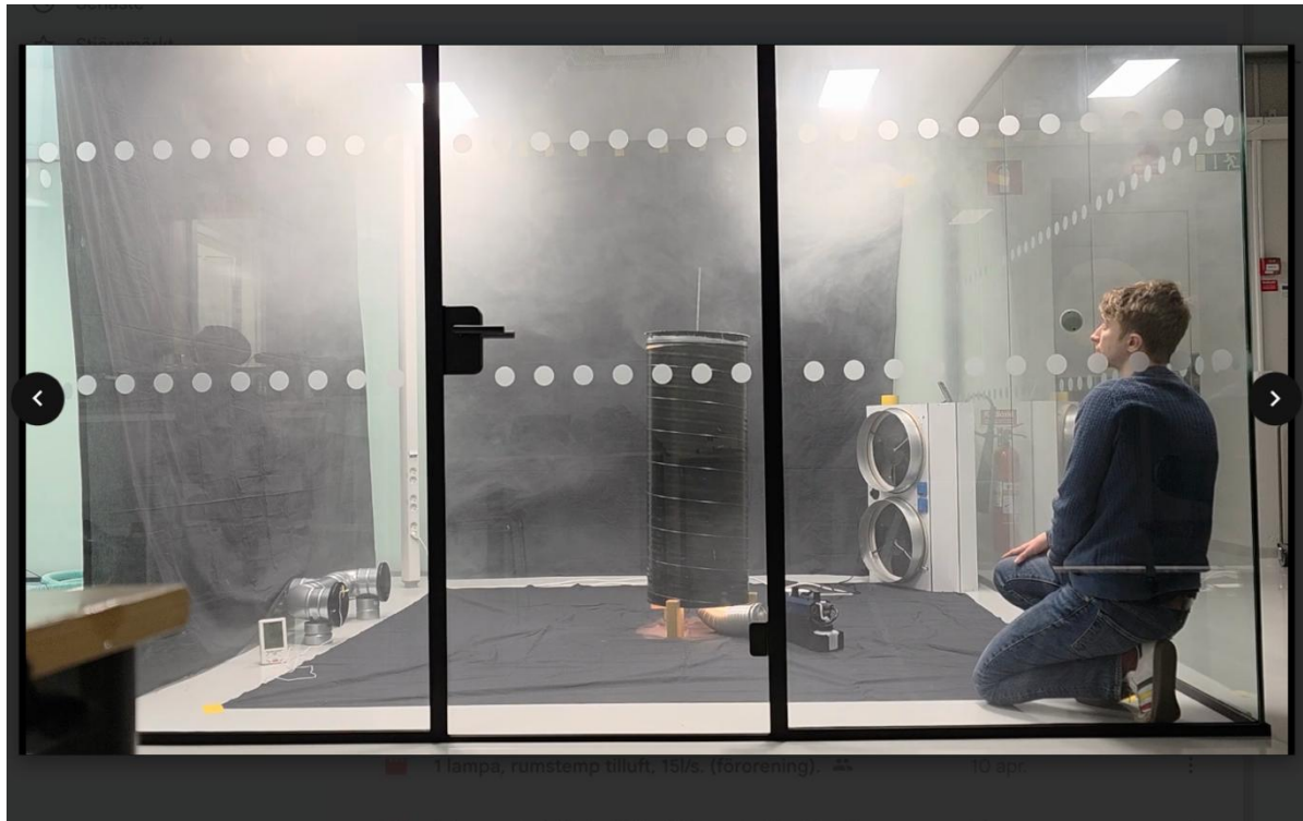
Figur 30: Rök som förorening, 150W, \Delta T=1,2-1,7^{\circ}\text{C} , 10 l/s efter 2 minuter. https://youtu.be/GOV6xk629UA
