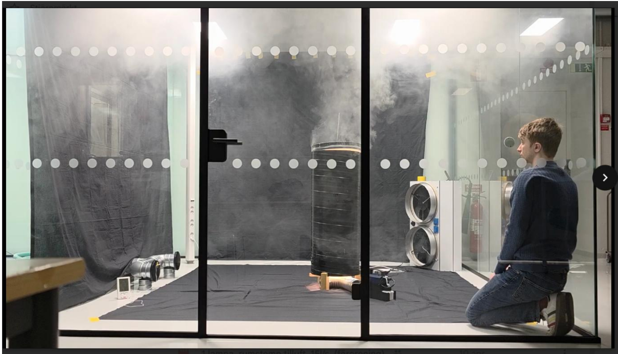
Bilaga 15: Rök som förorening, 225W, \Delta T=1,2-1,7^{\circ}\text{C} , 10 l/s efter 1 minut. https://youtu.be/zXM4_BSIyfs
