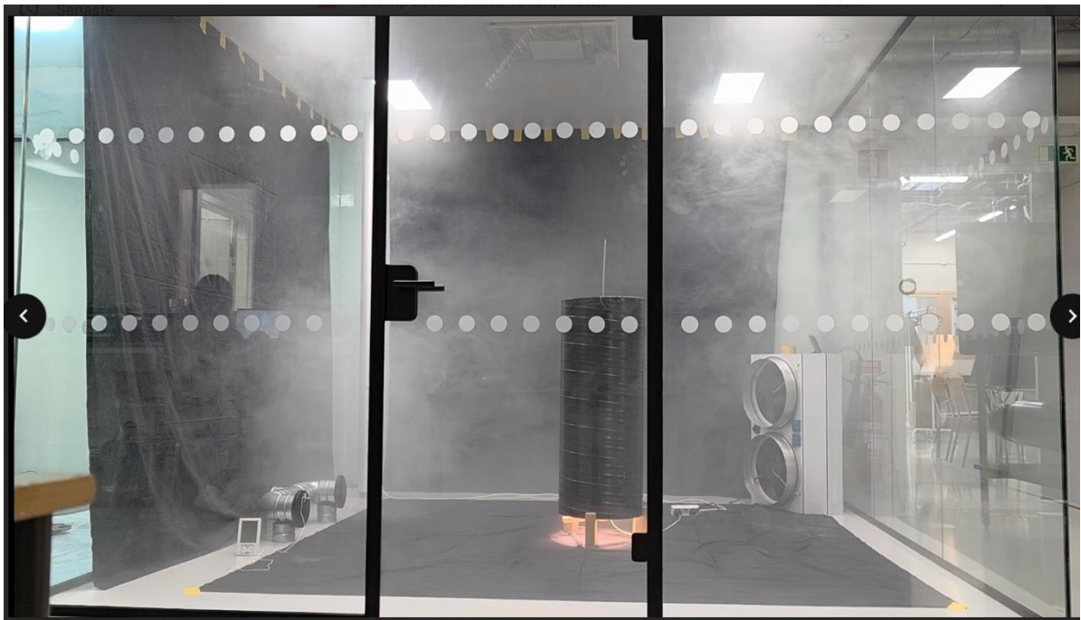
Bilaga 32: Rök som tilluft, 225W, \Delta T=0^{\circ}\text{C} , 15 l/s efter 2 minuter. https://youtu.be/eyYn6xtZeto
