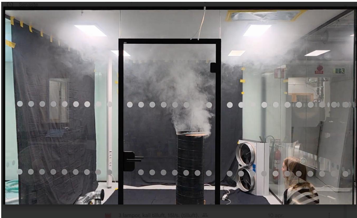
Figur 35: Rök som förorening, 150W, \Delta T=1,2-1,7^{\circ}\text{C} , 15 l/s efter 1 minut. https://youtu.be/l1IK3Adqsss
