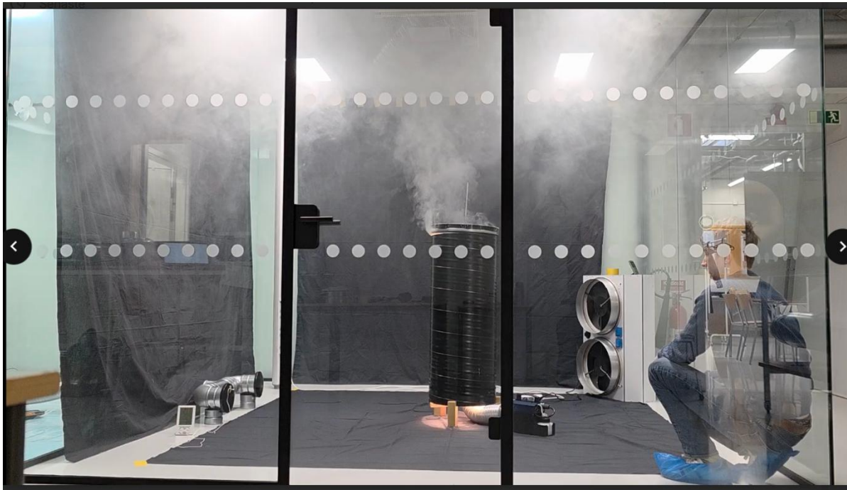
Figur 41: Rök som förorening, 150W, \Delta T=0^{\circ}\text{C} , 15 l/s efter 1 minut. https://youtu.be/448uTPf-43M
