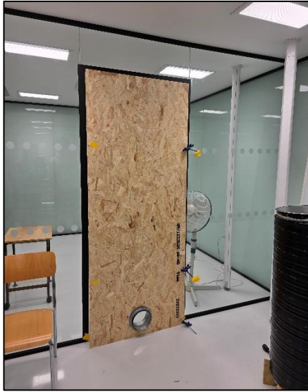
Figur 6. Spånskivan som fästes i dörröppningen.
