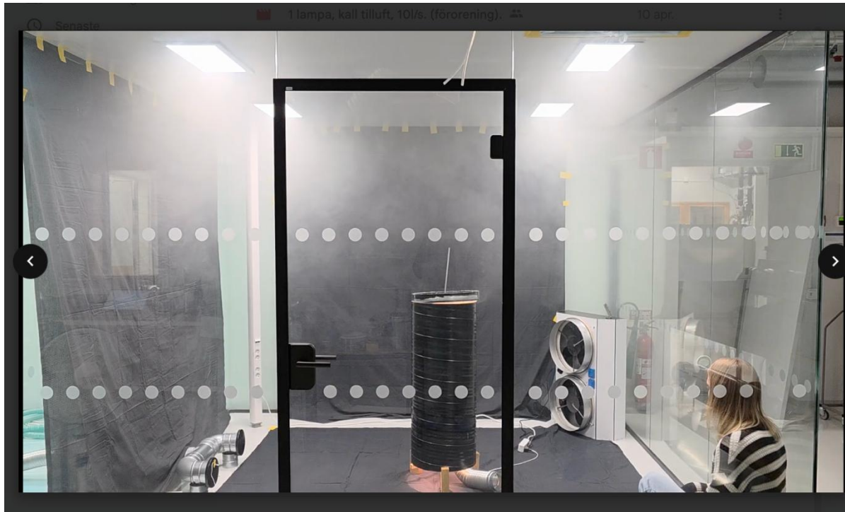
Figur 36: Rök som förorening, 150W, \Delta T=1,2-1,7^{\circ}\text{C} , 15 l/s efter 2 minuter. https://youtu.be/l1IK3Adqsss
