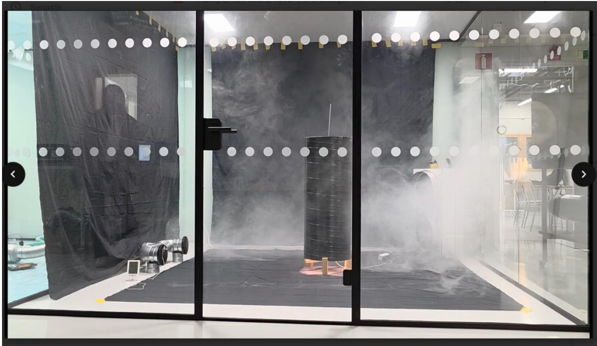
Bilaga 25: Rök som tilluft, 75W, \Delta T=0^{\circ}\text{C} , 15 l/s efter 1 minut. https://youtu.be/Q_5hVhUR0LQ
