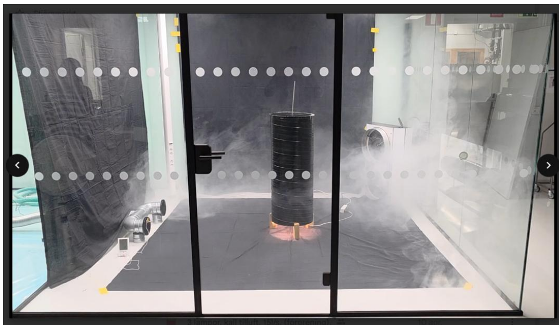
Figur 33: Rök som tilluft, 150W, \Delta T=1,2-1,7^{\circ}\text{C} , 15 l/s efter 1 minut. https://youtu.be/dCX_k2mv77Q
