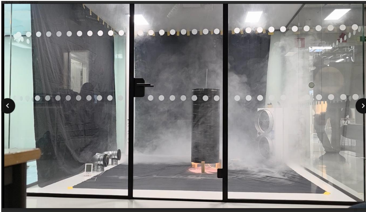
Figur 39: Rök som tilluft, 150W, \Delta T=0^{\circ}\text{C} , 15 l/s efter 1 minut. https://youtu.be/7QxUAHH8RGw
