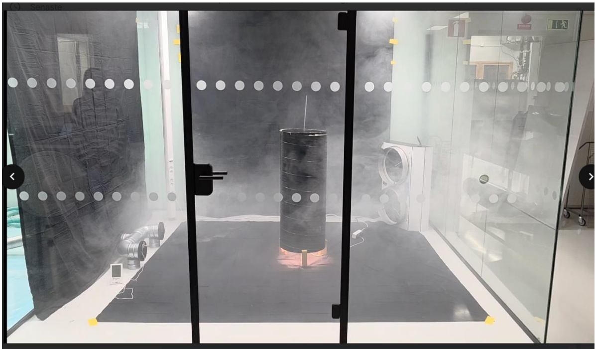
Bilaga 20: Rök som tilluft, 225W, \Delta T=1,2-1,7^{\circ}\text{C} , 15 l/s efter 2 minuter. https://youtu.be/J-rxY3gMp-8
