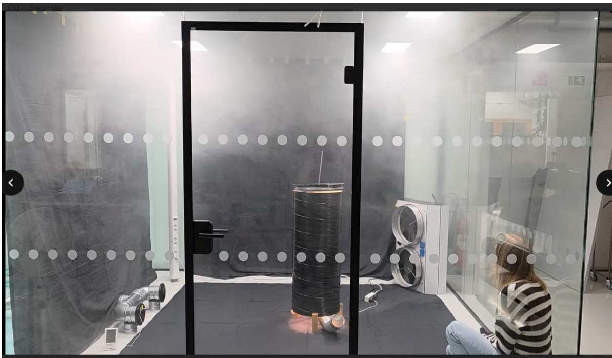
Bilaga 22: Rök som förorening, 225W, \Delta T=1,2-1,7^{\circ}\text{C} , 15 l/s efter 2 minuter. https://youtu.be/KwPFSKJJsOI
