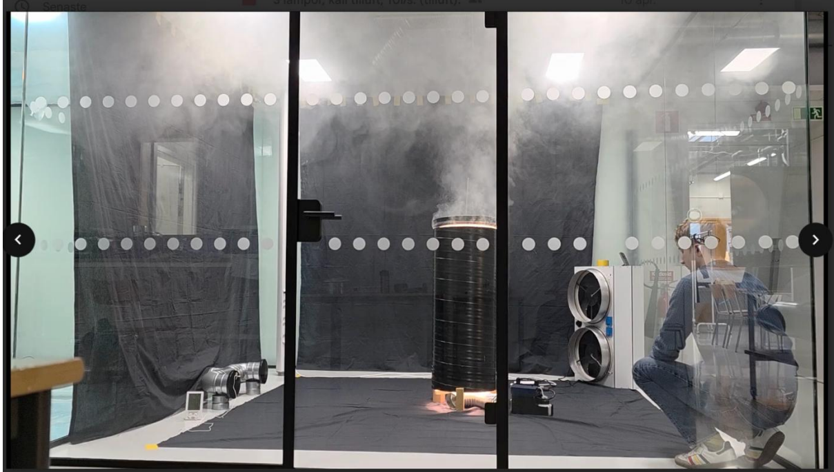
Bilaga 33: Rök som förorening, 225W, \Delta T=0^{\circ}\text{C} , 15 l/s efter 1 minut. https://youtu.be/Dq91qHNw5t0
