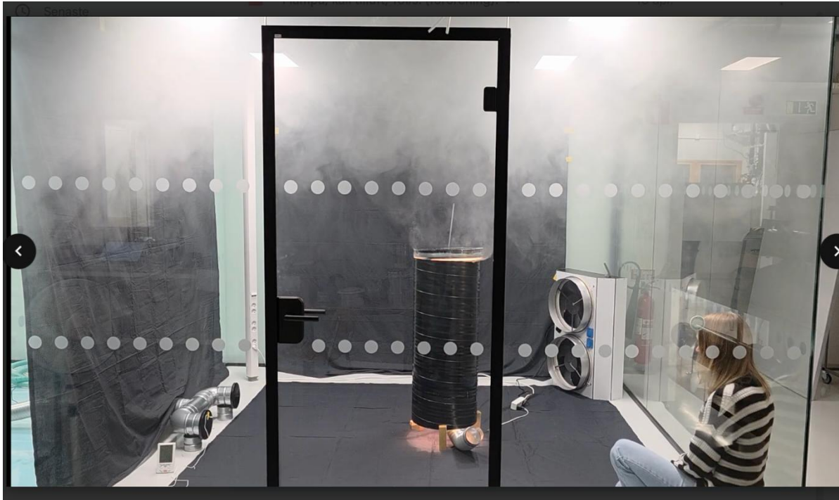
Bilaga 21: Rök som förorening, 225W, \Delta T=1,2-1,7^{\circ}\text{C} , 15 l/s efter 1 minut. https://youtu.be/KwPFSKJJsOI
