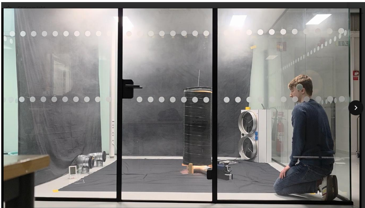
Bilaga 16: Rök som förorening, 225W, \Delta T=1,2-1,7^{\circ}\text{C} , 10 l/s efter 2 minuter. https://youtu.be/zXM4_BSIyfs
