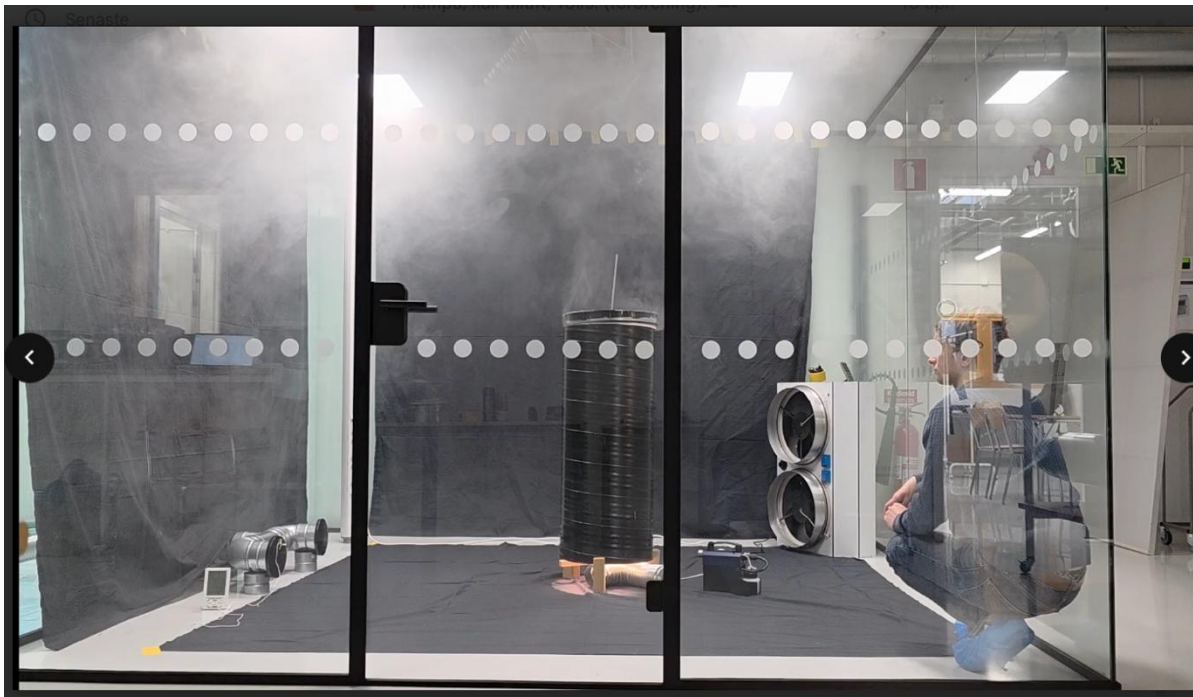
Bilaga 28: Rök som förorening, 75W, \Delta T=0^{\circ}\text{C} , 15 l/s efter 2 minuter. https://youtu.be/3FN1IAXj9m0
