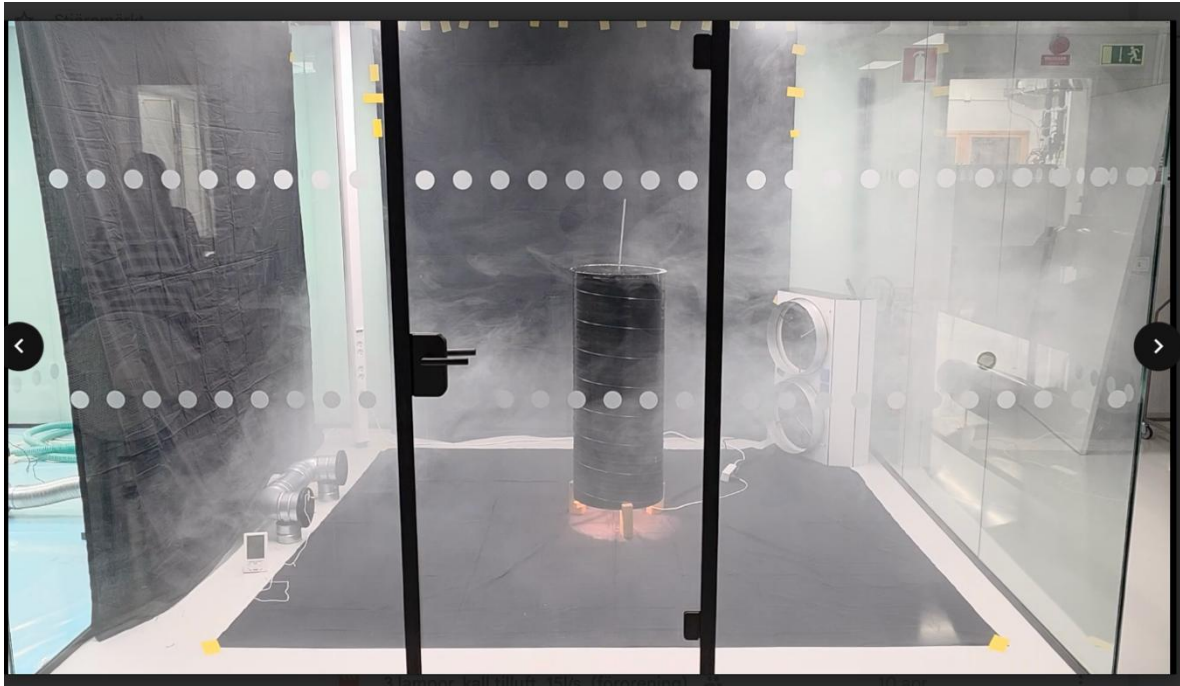
Figur 34: Rök som tilluft, 150W, \Delta T=1,2-1,7^{\circ}\text{C} , 15 l/s efter 2 minuter. https://youtu.be/dCX_k2mv77Q
