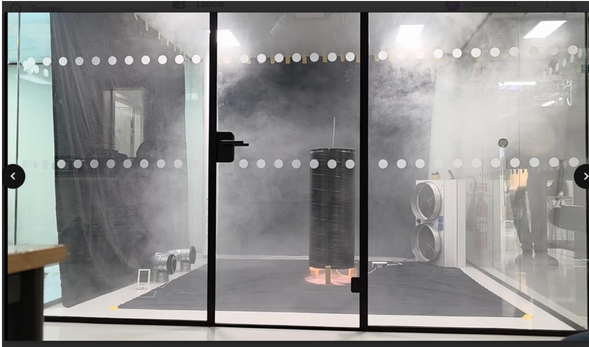
Figur 40: Rök som tilluft, 150W, \Delta T=0^{\circ}\text{C} , 15 l/s efter 2 minuter. https://youtu.be/7QxUAHH8RGw
