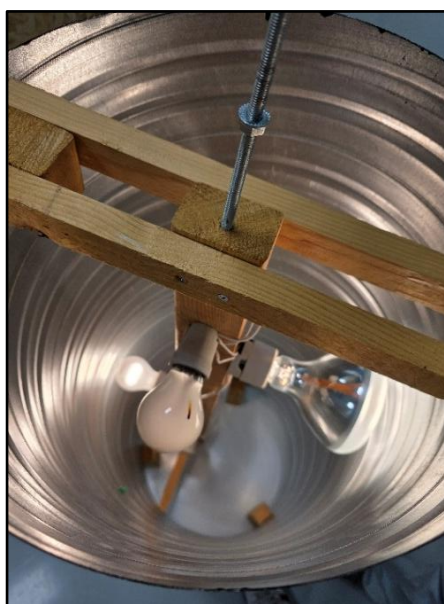
Figur 14. Insida av mannekäng (värmekälla).
