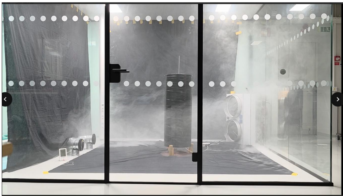
Bilaga 2: Rök som tilluft, 75W, \Delta T=1,2-1,7^{\circ}\text{C} , 10 l/s efter 2 minuter. https://youtu.be/pq-rZDFVSj8
