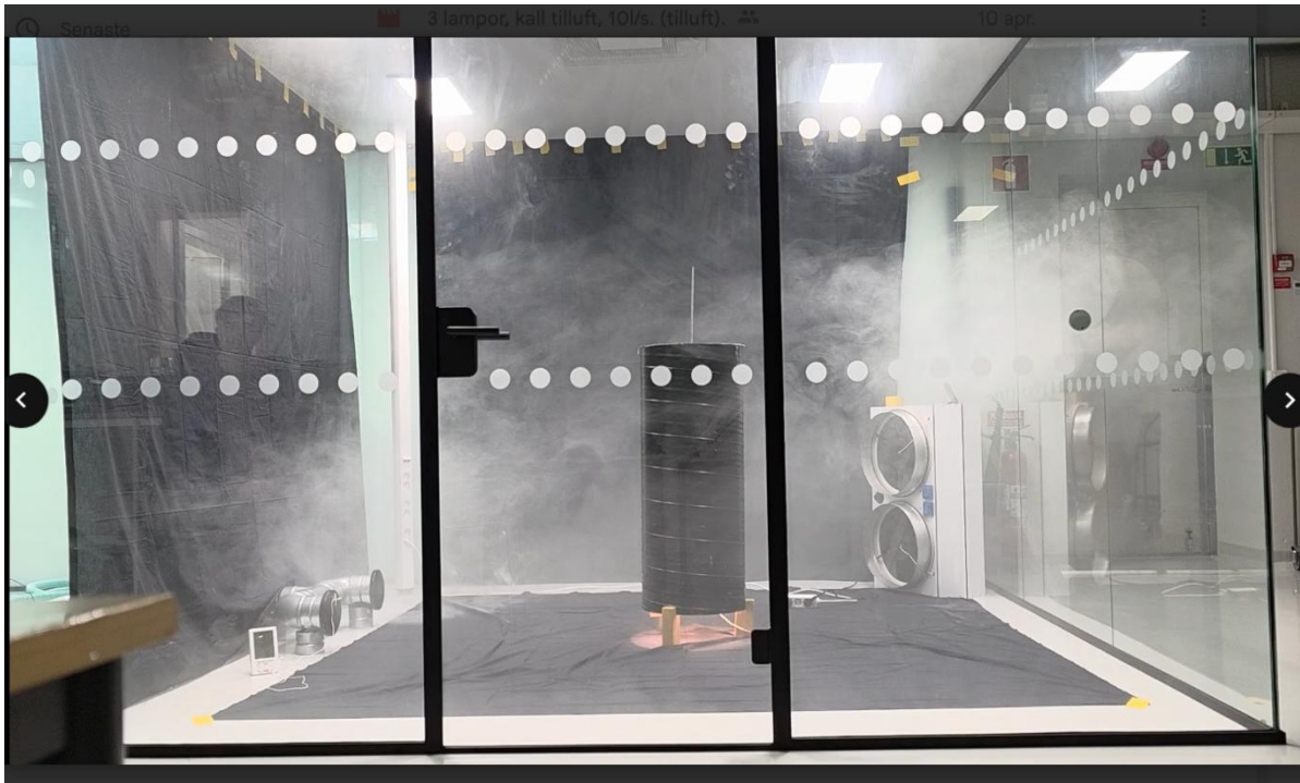
Figur 28: Rök som tilluft, 150W, \Delta T=1,2-1,7^{\circ}\text{C} , 10 l/s efter 2 minuter. https://youtu.be/eU8ayBcL_g4
