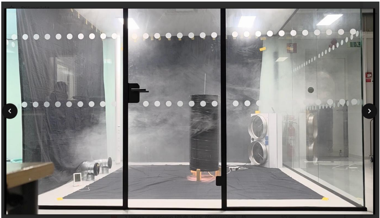
Bilaga 14: Rök som tilluft, 225W, \Delta T=1,2-1,7^{\circ}\text{C} , 10 l/s efter 2 minuter. https://youtu.be/iMI4Y4vhISl
