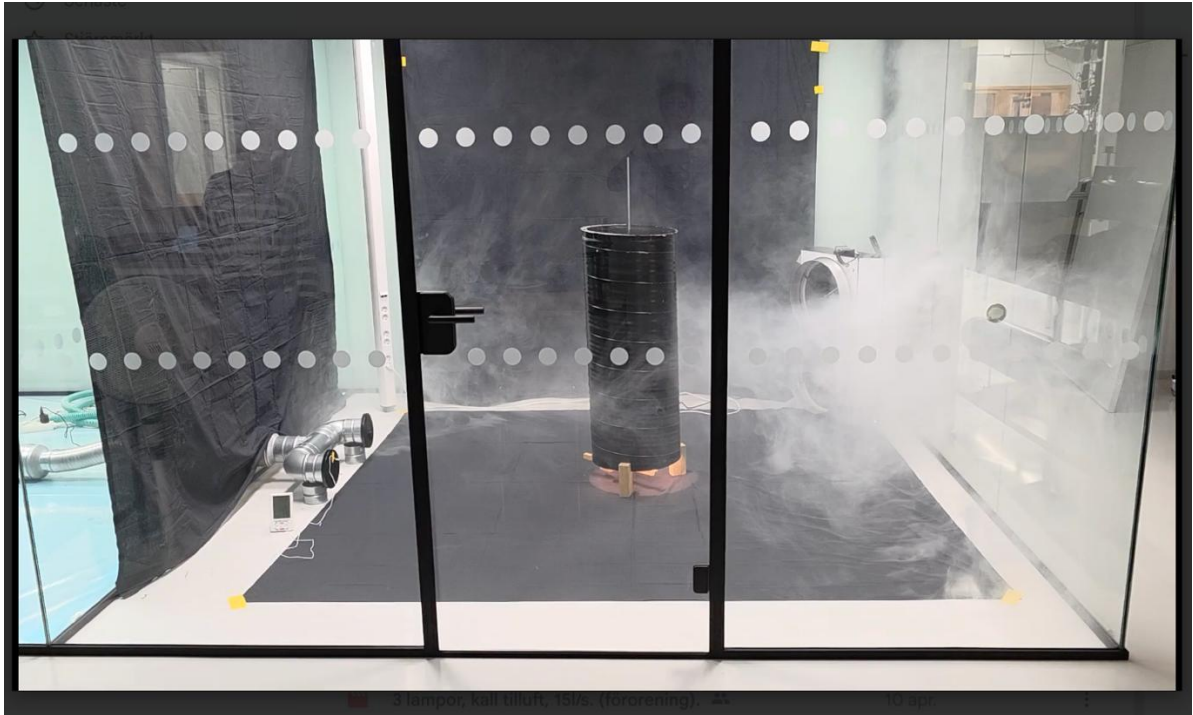
Bilaga 7: Rök som tilluft, 75W, \Delta T=1,2-1,7^{\circ}\text{C} , 15 l/s efter 1 minut. https://youtu.be/9lQrQ0VXnsM
