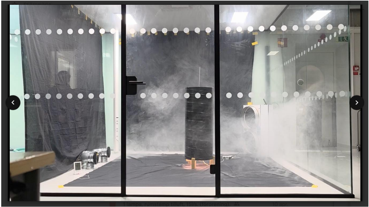
Bilaga 13: Rök som tilluft, 225W, \Delta T=1,2-1,7^{\circ}\text{C} , 10 l/s efter 1 minut. https://youtu.be/iMI4Y4vhISl
