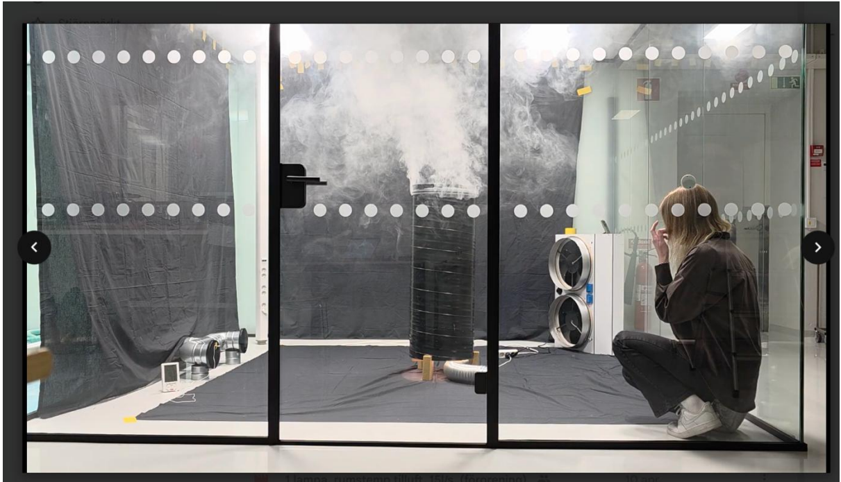
Bilaga 3: Rök som förorening ,75W, \Delta T=1,2-1,7^{\circ}\text{C} , 10 l/s efter 1 minut. https://youtu.be/K-NrkSd5ocs
