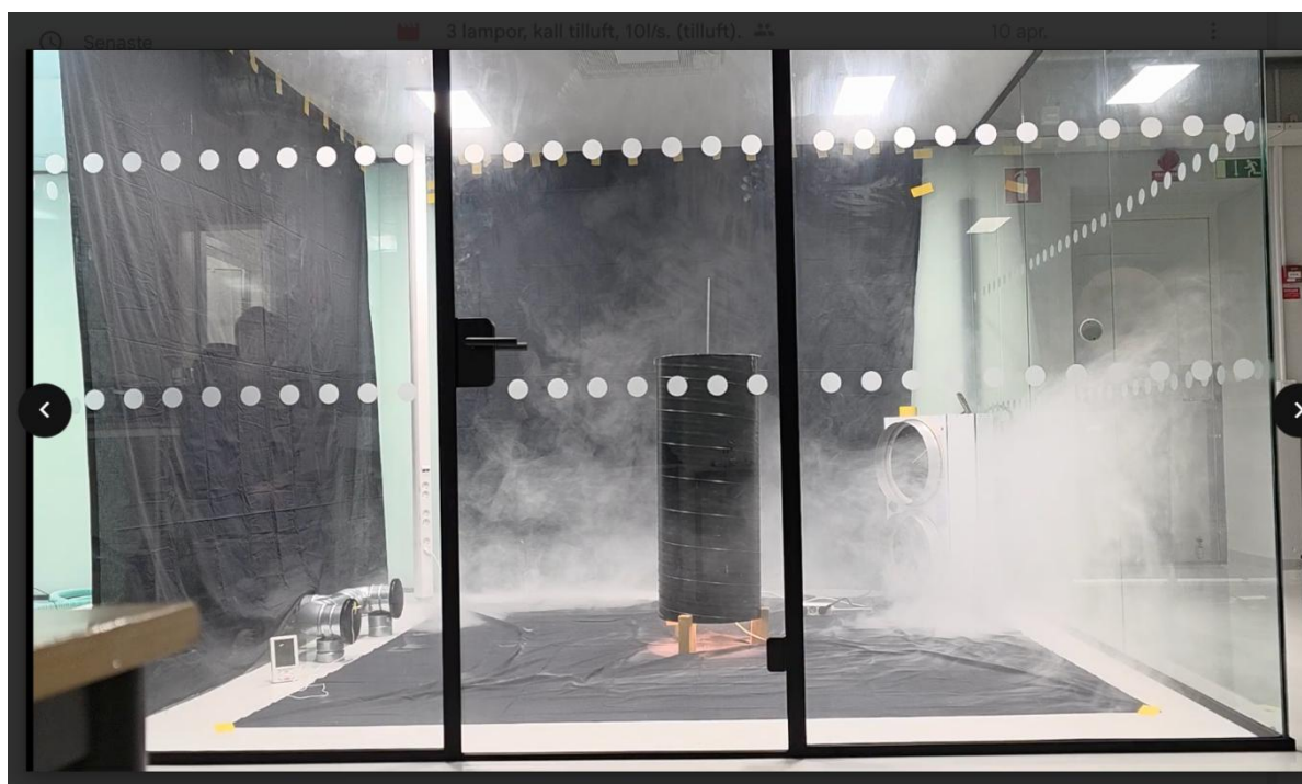
Figur 27: Rök som tilluft, 150W, \Delta T=1,2-1,7^{\circ}\text{C} , 10 l/s efter 1 minut. https://youtu.be/eU8ayBcL_g4
