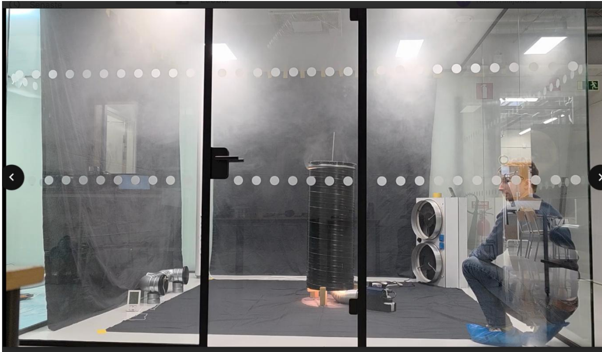
Figur 42: Rök som förorening, 150W, \Delta T=0^{\circ}\text{C} , 15 l/s efter 2 minuter. https://youtu.be/448uTPf-43M
