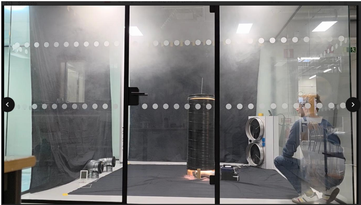
Bilaga 34: Rök som förorening, 225W, \Delta T=0^{\circ}\text{C} , 15 l/s efter 2 minuter. https://youtu.be/Dq91qHNw5t0
