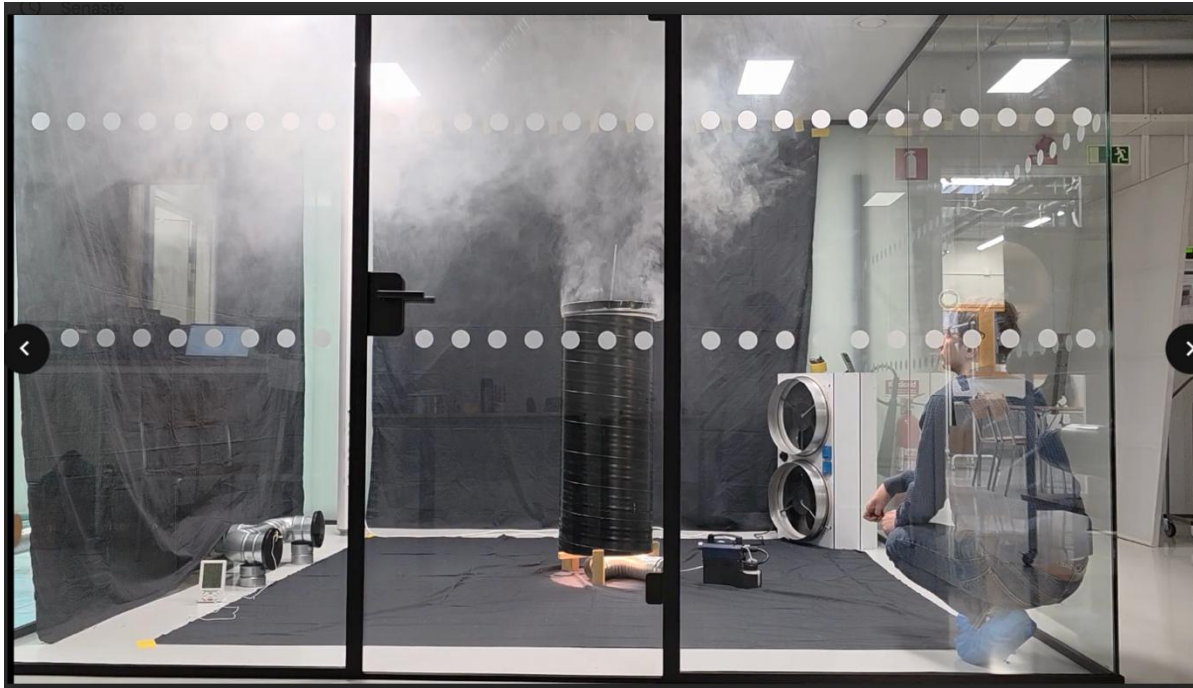
Bilaga 27: Rök som förorening, 75W, \Delta T=0^{\circ}\text{C} , 15 l/s efter 1 minut. https://youtu.be/3FN1IAXj9m0
