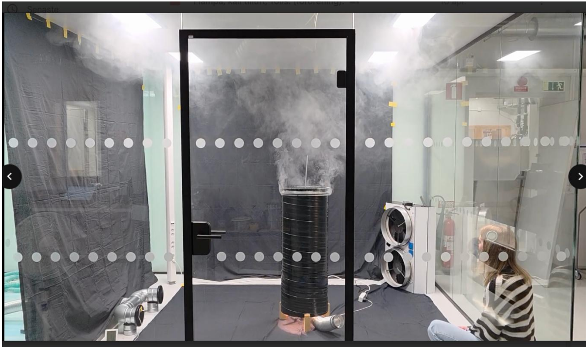
Bilaga 9: Rök som förorening, 75W, \Delta T=1,2-1,7^{\circ}\text{C} , 15 l/s efter 1 minut. https://youtu.be/1TZb556WtGs
