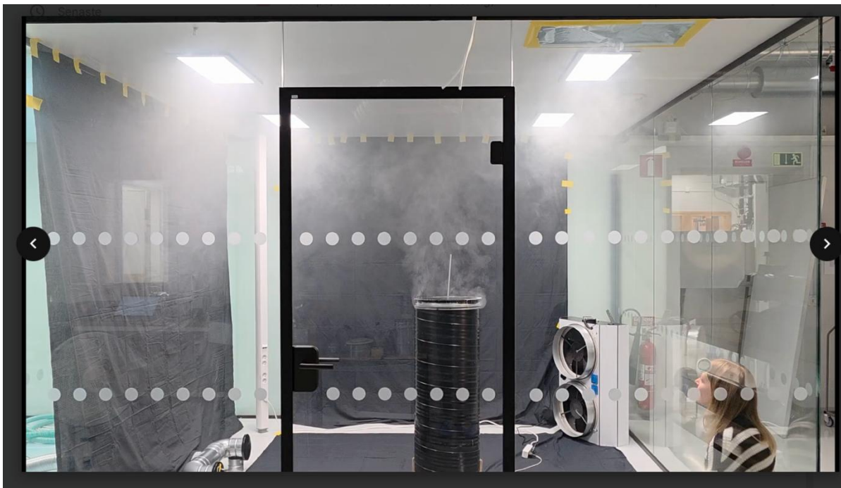
Bilaga 10: Rök som förorening, 75W, \Delta T=1,2-1,7^{\circ}\text{C} , 15 l/s efter 2 minuter. https://youtu.be/1TZb556WtGs
