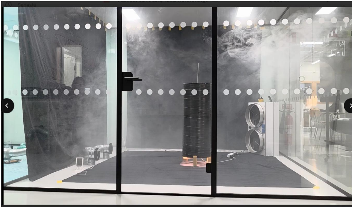
Bilaga 26: Rök som tilluft, 75W, \Delta T=0^{\circ}\text{C} , 15 l/s efter 2 minuter. https://youtu.be/Q_5hVhUR0LQ
