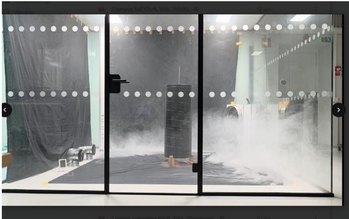
Bilaga 1: Rök som tilluft, 75W, \Delta T=1,2-1,7^{\circ}\text{C} , 10 l/s efter 1 minut. https://youtu.be/pq-rZDFVSj8
