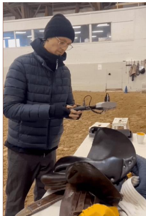
Figur 4. Stillbild från utförande av 3D-skanning på en sadel.
