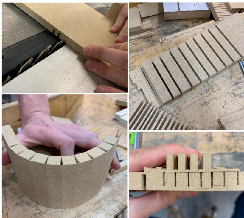
Figur 13: Test av kerfing
