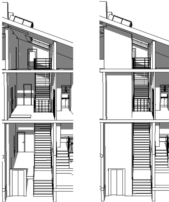
Figur 38 & 39. Tvärsnitt som visar trapphus från väster. Till vänster (figur 38) visas den långsträckta trappan från markplan till vindsvåning och till höger (figur 39) visas hissens placering genom samtliga våningar. Producerat i Revit.
