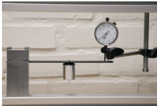
Figur 5: Fallet fast inspänd konsolbalk visualiserat i balkriggen
