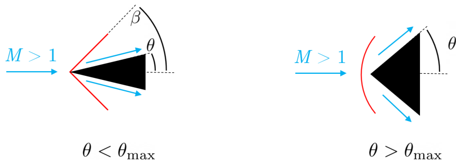
Figur 2.2: Schematisk representation över en snedstötuvåg respektive en bogstötuvåg, bildad från överljudsströmning runt en kilformad kropp. För en spetsig kil med \theta < \theta_{\max} bildas en snedstötuvåg, medan en bogstötuvåg bildas för en trubbig kil med \theta > \theta_{\max} . Luftflödet är markerat i blått, och stötuvågorna i rött.
