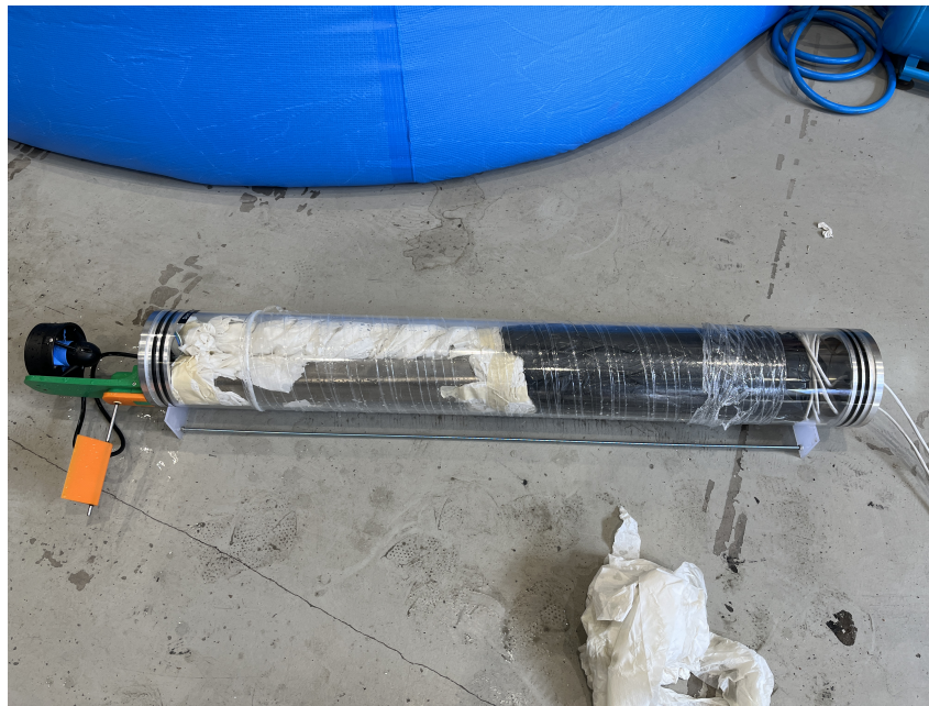
Figur 4.2: Glidern vid test 4 gällande täthet. Röret fyllt med metallskrot och tösalt för ökad tyngd. Även papper för att spåra läckage.
