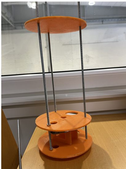
Figur 4.6: Test av modulärt koncept. Tre 3D-utskrivna diskar monterade med muttrar varav två diskar klämmer och låser fast två plattor.
