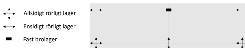
Figur 8: Placering av brolager
