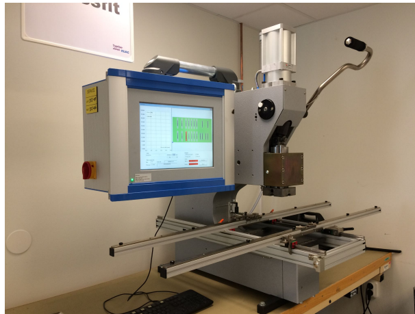
Figur 5. Den digitala pressfitmaskinen med tillhörande datorskärm.
