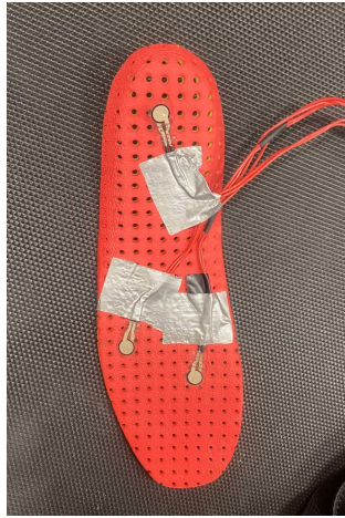
(a) Töjningsgivarnas placering under sulan.
