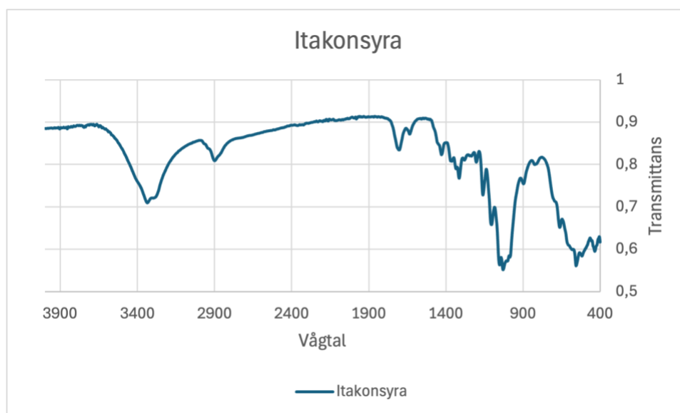
Figur 13: FTIR-spektrum för CNC-behandlad med itakonsyra analyserat inom området 400–3900 \text{cm}^{-1} . Spektrumet visar karakteristiska band från cellulosastrukturen men inga tydliga indikationer på esterbildning.
