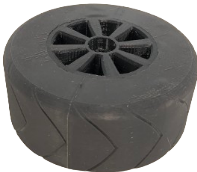
Figur 3.16: Ett färdigt hjul till dragfordonet. Fälgan är gjord i plast och däcken är gjutna i silikon.
