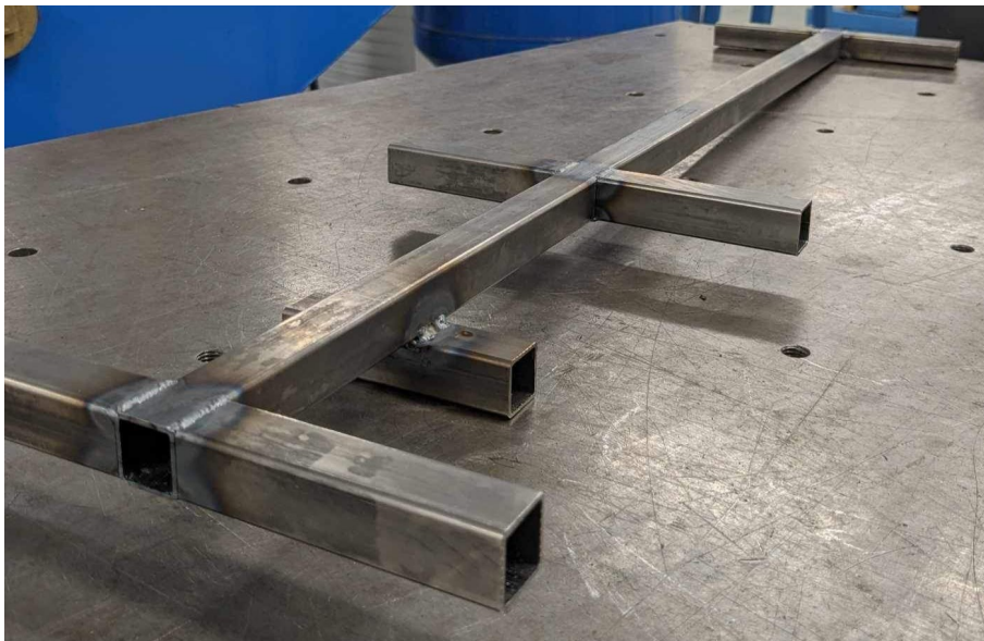
Figur 3.17: Den delen av semitrailerns stomme som tillverkats i 20 mm x 20 mm fyrkantör.
