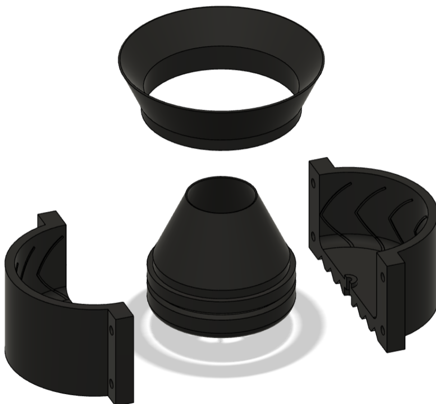
Figur 3.15: Gjutform för både dragfordon- och semitrailerdäck med fälg och tillhörande trattar. Bilden är gjord i CAD.
