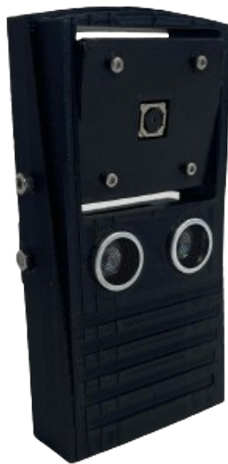
Figur 3.26: Dragfordonets sensorfäste med monterad kamera och ultraljudssensor.
