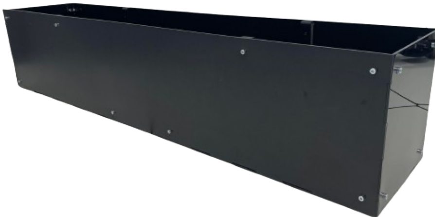
Figur 3.20: Containern i skala 1:12 av en verklig 40 fots container. Den är byggd av akrylplast.
