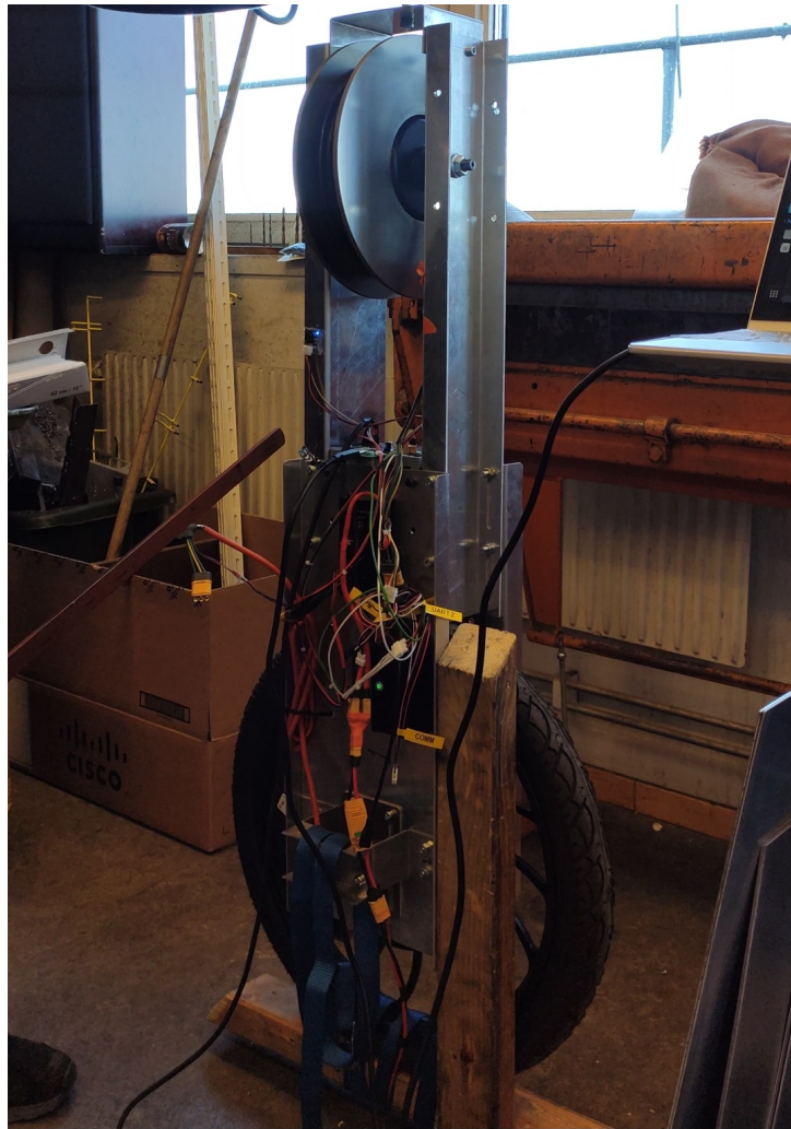
Figur 6.2: Prototyp fixerad för att testa enbart balansering i roll
