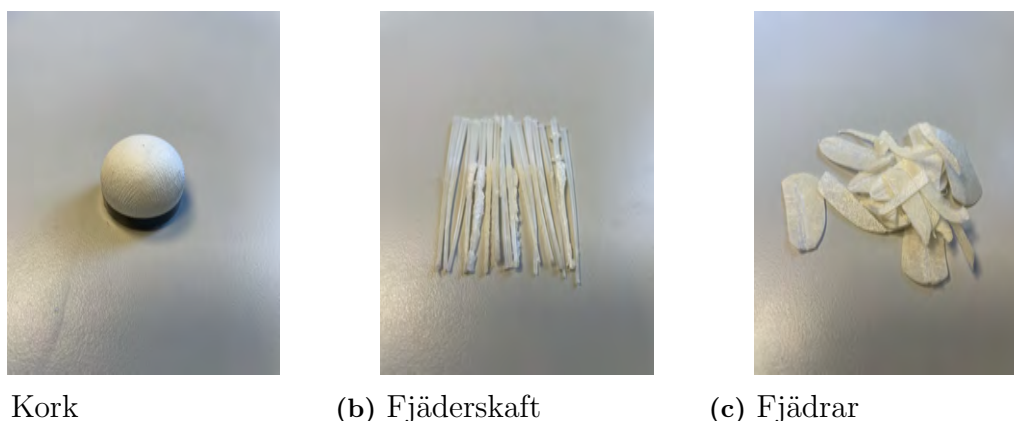
Figur 3.5: Syntetbollen Mizuno Tech (5.1g) isärklippt i olika delar
