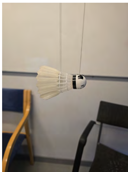
Figur 3.11: Upphängning av badmintonbollen i bifilar swing experimentet, för att mäta I_{zz} , I_{yy} .
