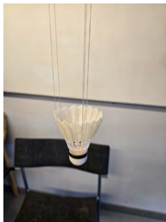
Figur 3.9: Upphängning av badmintonbollen i trifilar swing experimentet, för att mäta I_{xx} .
