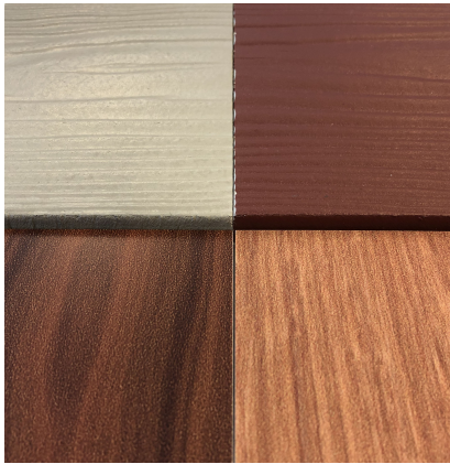
Figur 4.5: Bild på materialprover som visar hur fasadskivorna efterliknar äkta trä.
