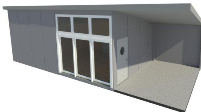
Figur 6.2: Förlängning av tak och vägg.
