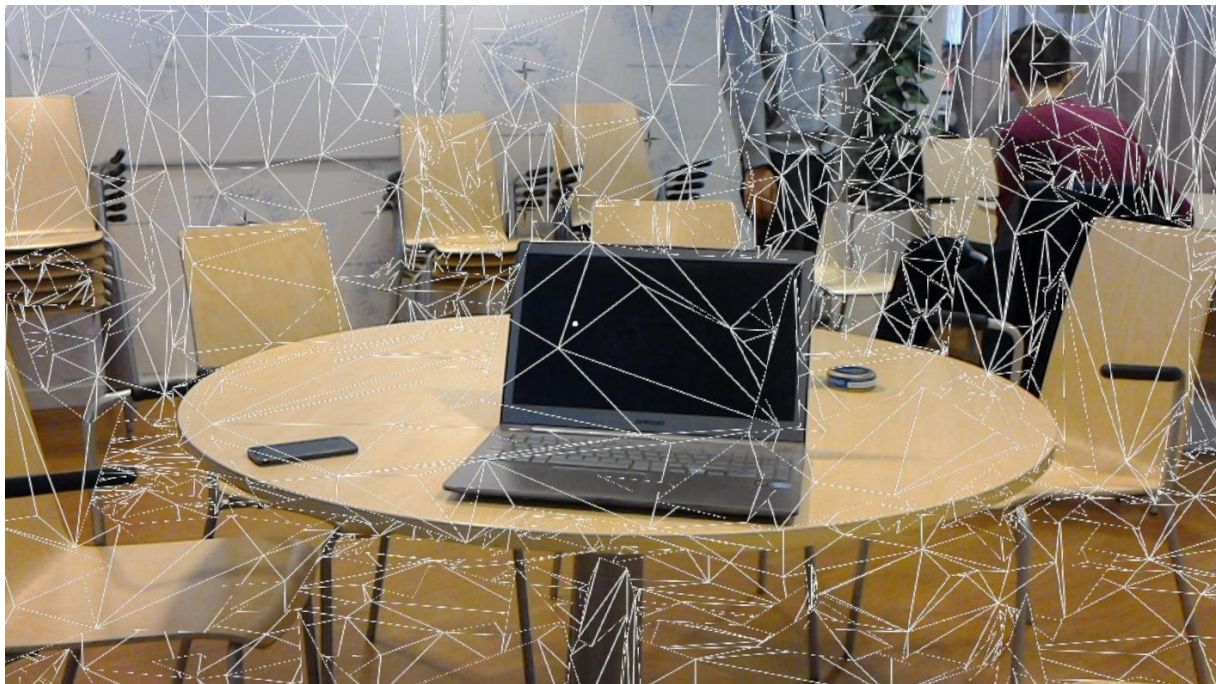
Figur 2.17 Spatial mappning för HoloLens.
