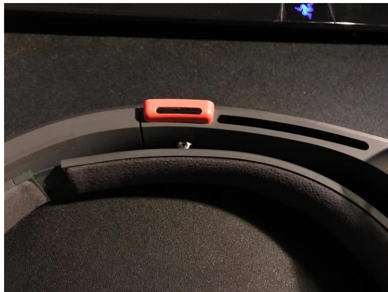
Figur 2.12 HoloLens audio display(högtalare)
