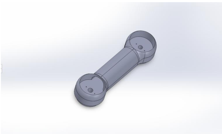
Figur 10: Arm 1 sedd ovanifrån med synlig kabelkanal
