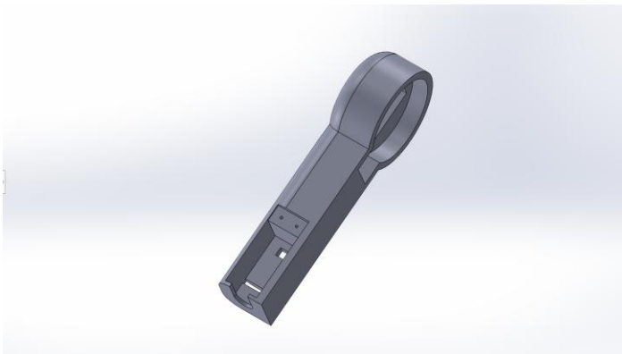
Figur 13: Utskärning i Arm 2 för servo som styr roll
