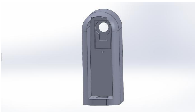
Figur 17: Servoförsänkning för SG90
