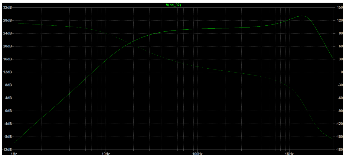
Figur 5.4: Kretsens totala frekvenssvar
