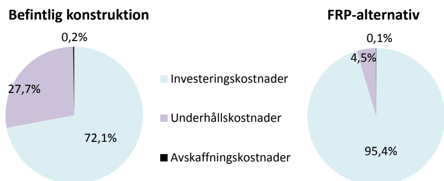
Figur 5.21 Kostnadsfördelning mellan investerings-, underhålls- och avskaffningskostnader för Bro VI – 15-1520-1 – Häggån.
