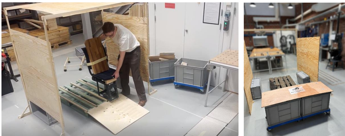
Figur 24 - Bild på mockup enligt minsta färdtjänstfordon och på representation av fordonens innergolvshöjd.
