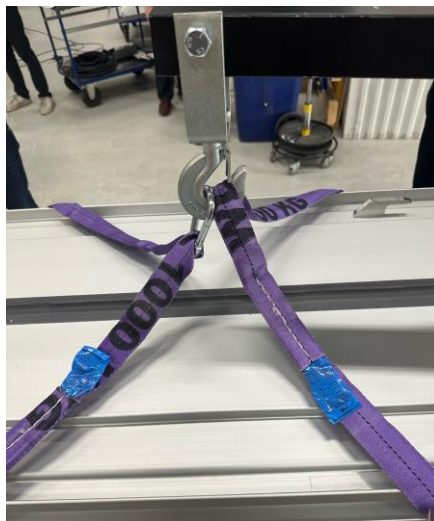
Figur 7 - Dellösning som möjliggör säkra och stabila lyft.
