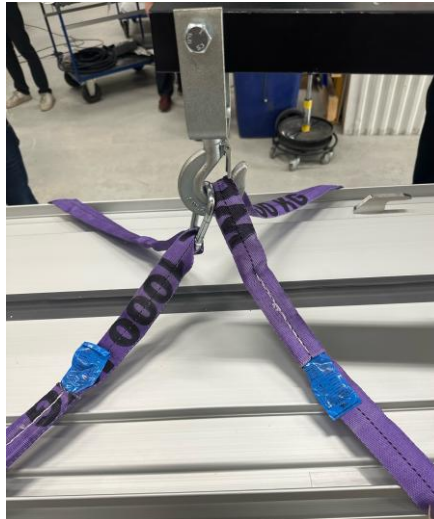
Figur 36 - Stropparnas utformning och hur infästning ser ut vid användning.
