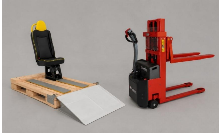
Figur 1 - Rendering av Specialpall modellerad i CAD-program CATIA samt Logitrans Logiflex SELF MINI.
