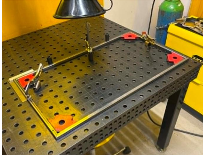
Figur 27 - Bild vid tillverkning av stålram för rampen.
