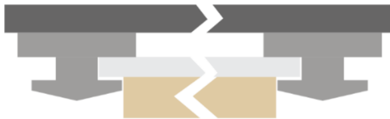
Figur 4 - Illustration av hur stolsbenen glider ovanpå spåren och motverkar vältning vid transport.
