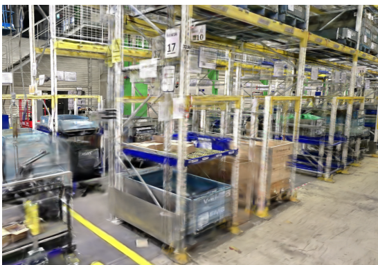
Figur 3.17: 3DGS-modell av inskaning A, som visar dubbla geometrier av miljön.
