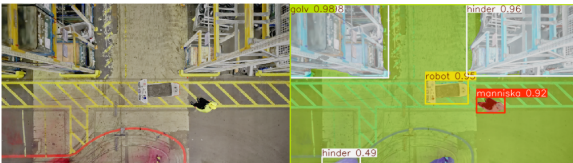
Figur 4.10: I bilden till vänster visas originalbilden från kamerorna i den simulerade fabriken. Till höger visas den segmenterade bilden ovanpå original bilden. Klasserna representera som följande: vitt för hinder, gult för robot, rött för människa och grönt för golv
