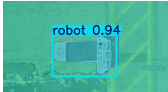
Figur 5.9: Framtagning av objektets centroid enligt ekvation 5.2. Variablerna x_{min} och x_{max} representerar objektets övre respektive nedre gräns i bilden, medan y_{min} och y_{max} representerar den vänstra respektive högra gränsen. Centroiden (x_c, y_c) beräknas som mitten av begränsningsrutan i pixelkoordinater.
