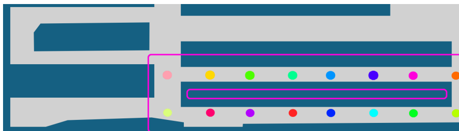
Figur 4.3: Placering av statiska kameror vid användande av simuleringsläge. Prick motsvarar kamerans placering, fyrkant motsvarar grovt det område som avbildas och streckad linje motsvarar kameransfärdväg.
