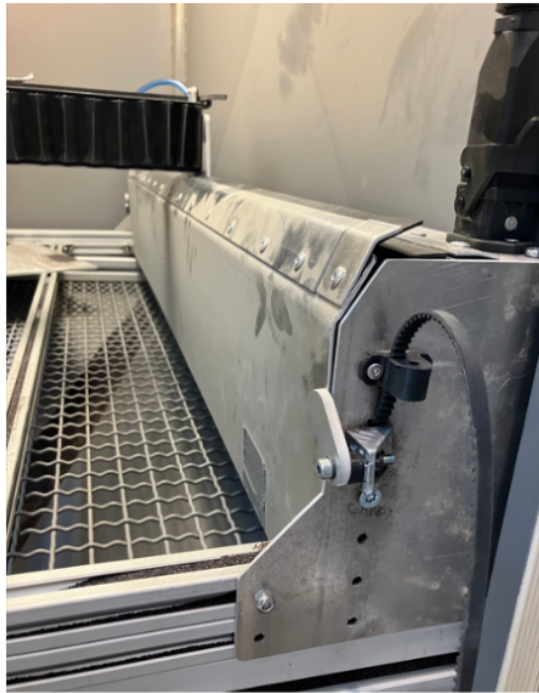
Figur 4.4: Framskyddet på x-axeln och hur den låses fast
