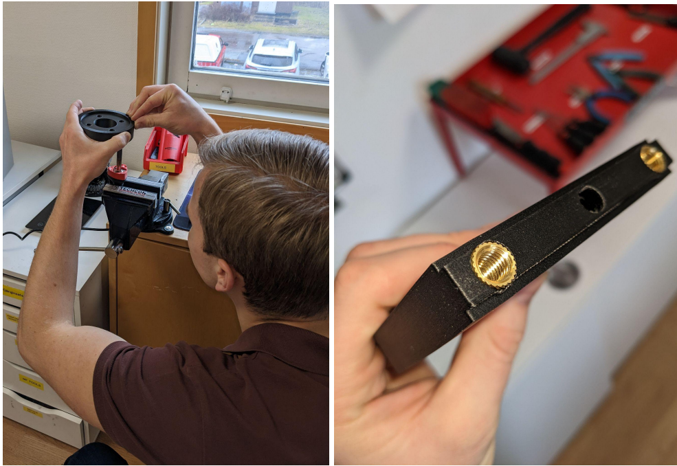
Figur 51 - Montering av gänginsatser
