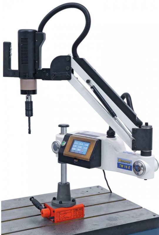
Figur 4 - Monterad avlastningsarm med hjälp av magnet Från TM 12 E [foto], av LTS Maskin AS, 2023 [6]
